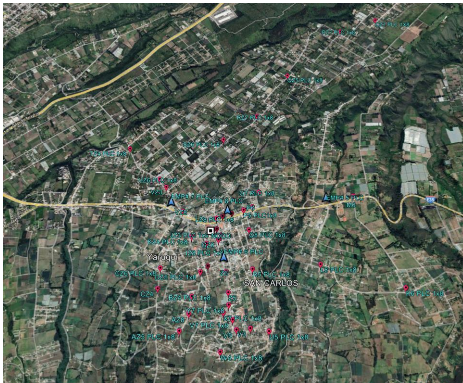
Figura 47. Ubicación de los splitters de primer nivel
