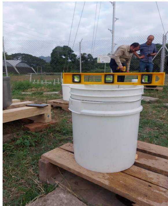
Figura 9: Nivelación de los recipientes
