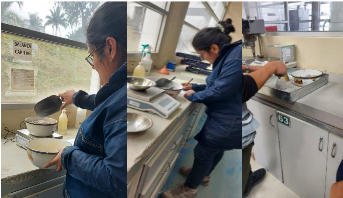
Proporciones de los materiales para la elaboración de las probetas cilíndricas de hormigón para una resistencia de 350 kg/cm 2 .
