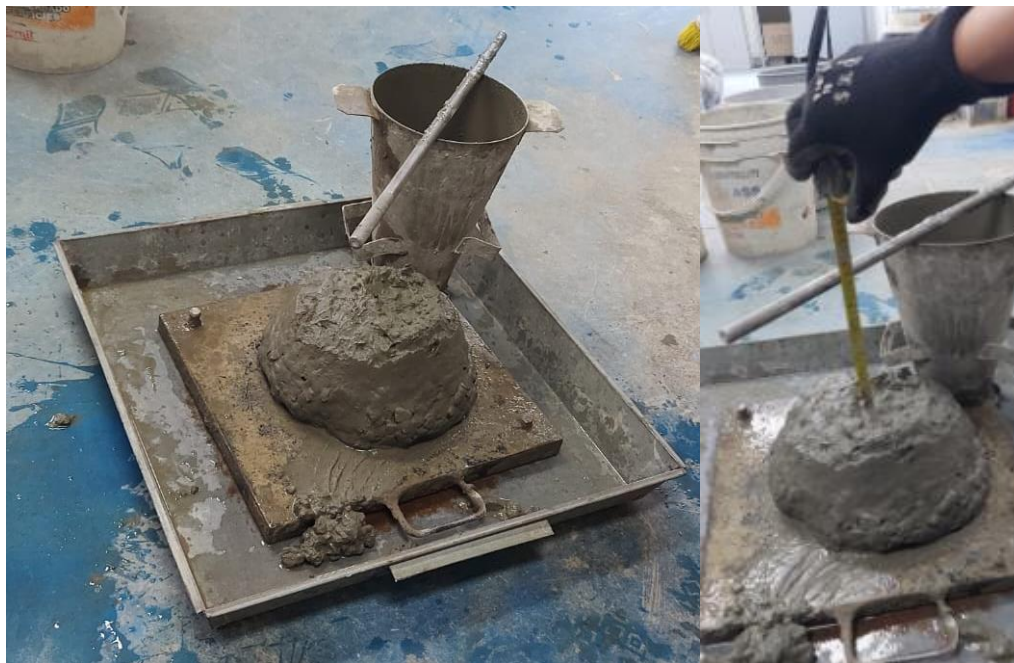
Ensayo del cono de Abrams para medir la consistencia del concreto fresco (Asentamiento)
