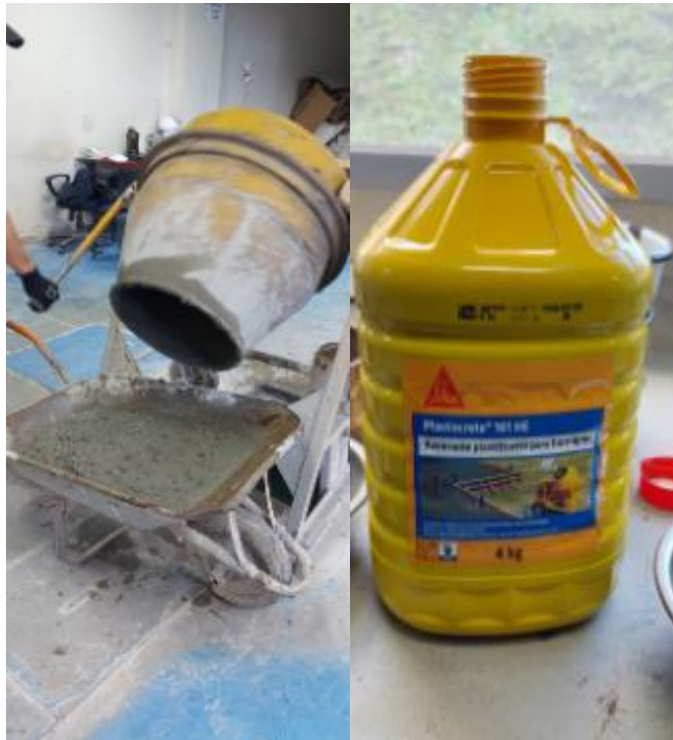
Dosificación con aditivo plastificante en probetas cilíndricas de hormigón para una resistencia de 350 kg/cm 2 .
