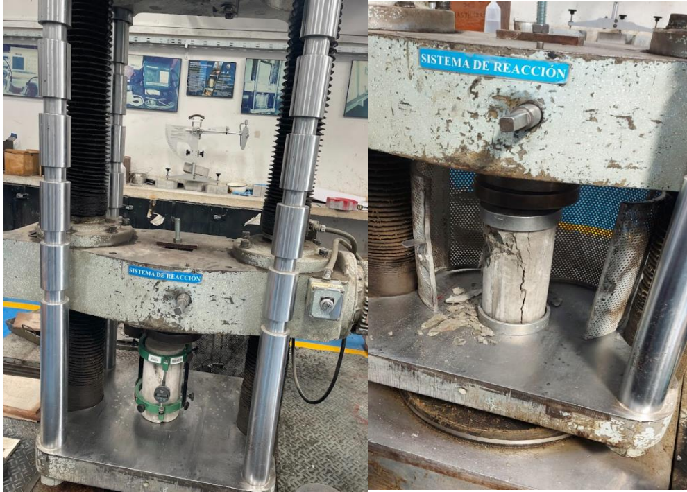
Colocación de probeta cilíndrica de hormigón en el compresómetro para ensayo de resistencia a la compresión y módulo de elasticidad
