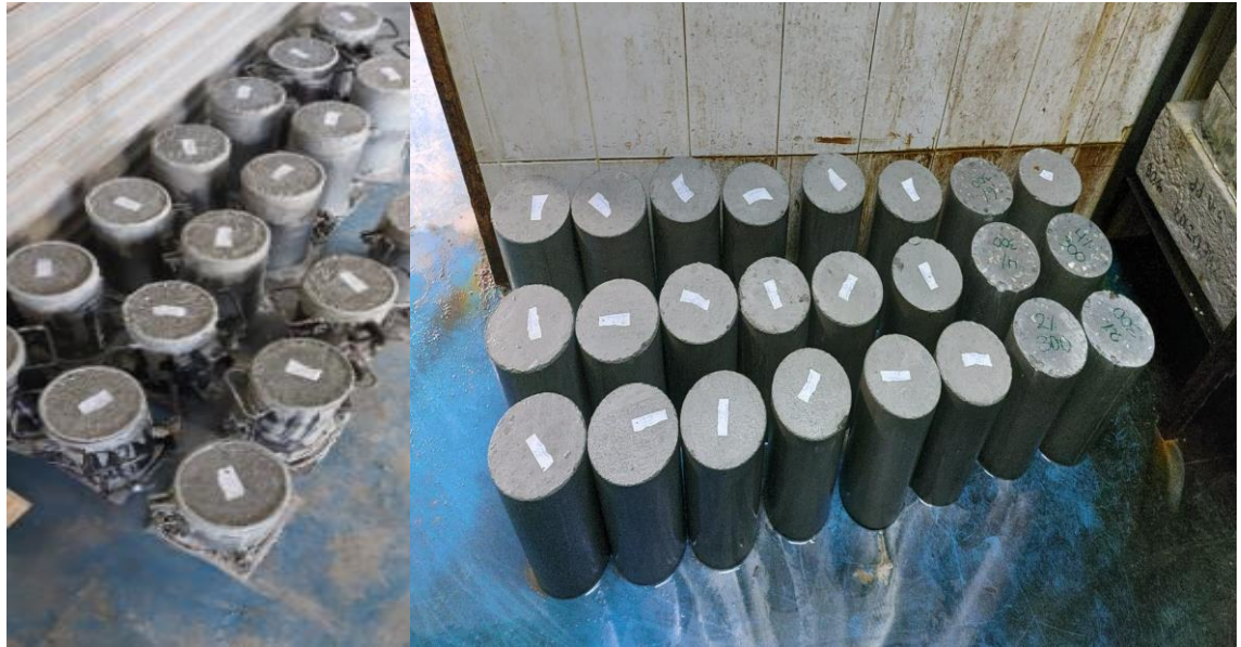
Encofrado/desencofrado de probetas cilíndricas de hormigón con inclusión de material reciclado (adoquín
