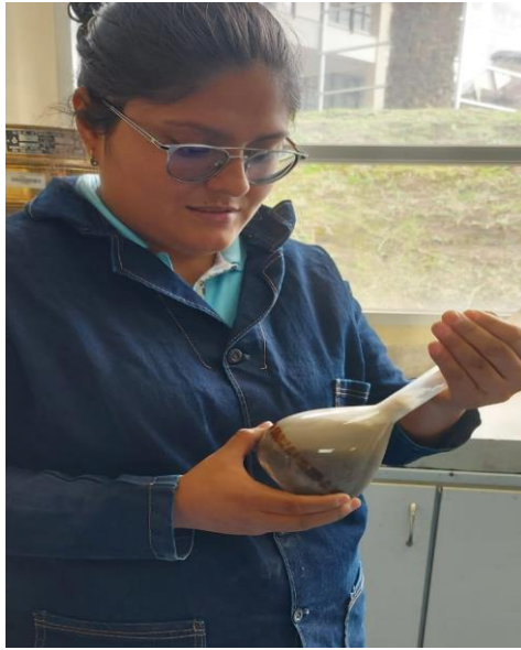
Ensayo de determinación de la densidad, densidad relativa (gravedad específica) y la absorción de agregados.
