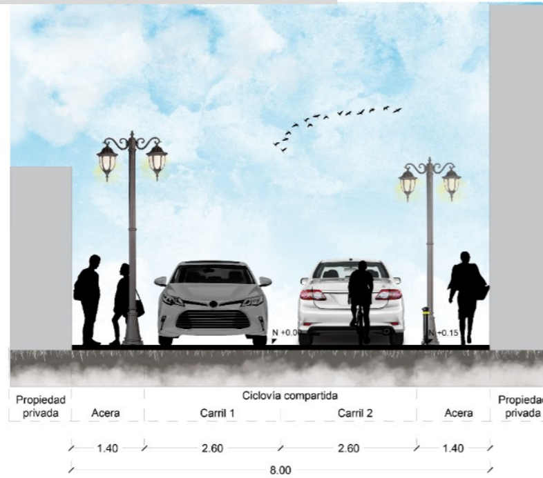
SECCIÓN A - A' TRAMO VÍA 8m Esc -----1:100
