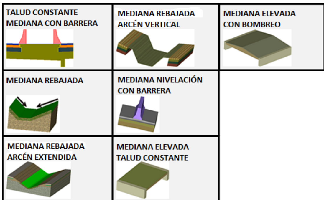
FIGURA 2. 109 Subensamblajes de medianas
