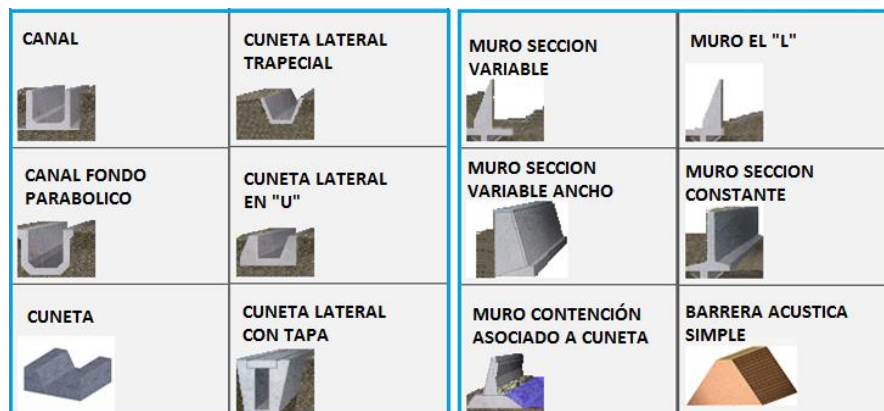
FIGURA 2. 103 Subensamblajes canales y muros de contención
