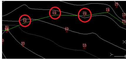
FIGURA 2. 47 Crear línea de Breaklines
