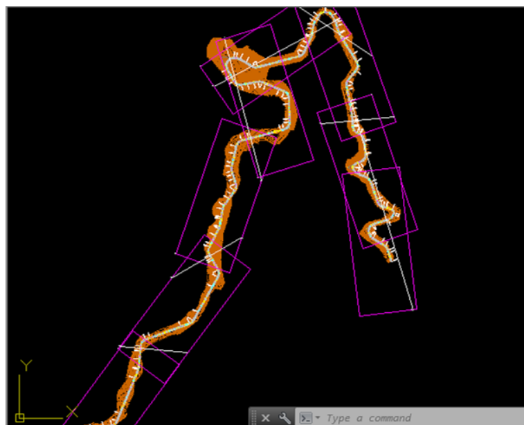
FIGURA 2. 195 Generar grupo de láminas en planta
