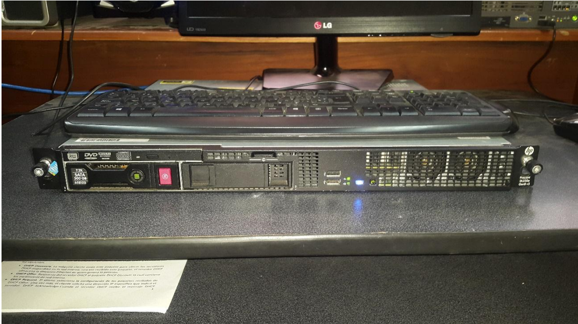
Figura 10: El servidor HP ProLiant DL380G5 realiza la distribución de IP por DHCP e Internet.
