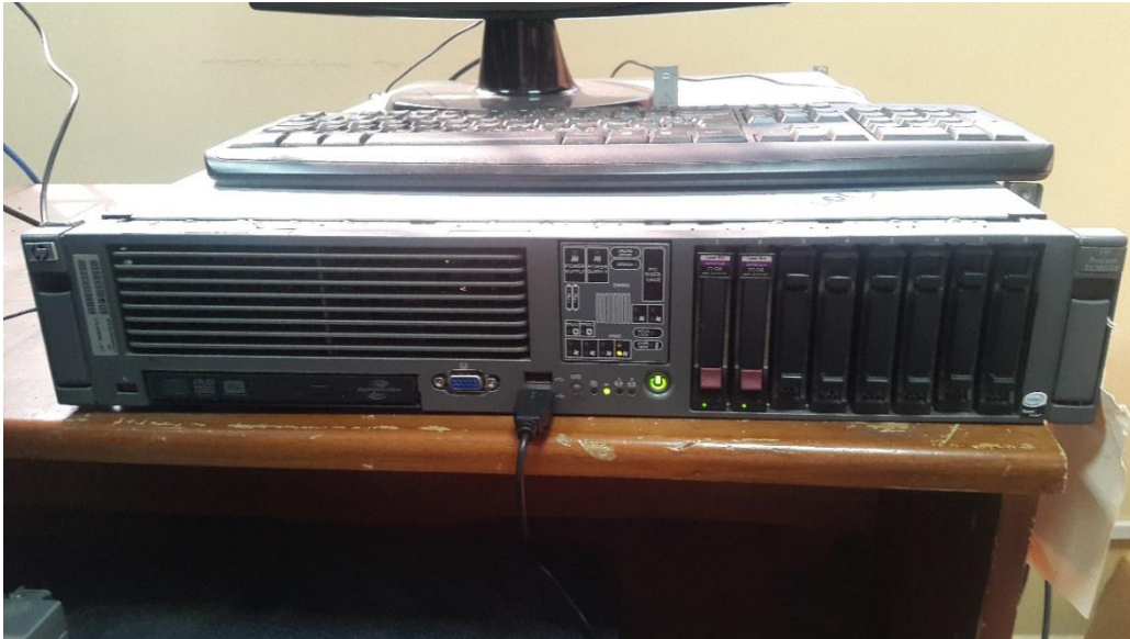
Figura 9: El servidor HP ProLiant DL320e realiza la distribución de IP por DHCP e Internet
