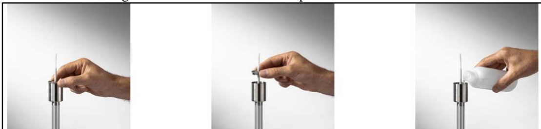
Fig. 13. Armado de Sonda - Temperatura Bulbo Húmedo
