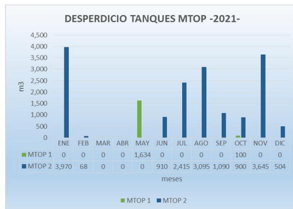
Figura 3.10: Pérdidas por fuga de los tanques de la MTOP en 2021
