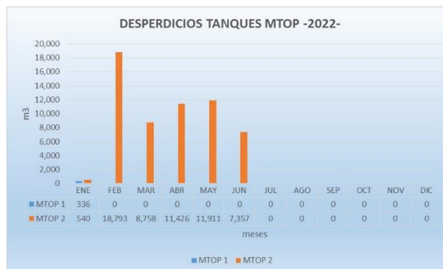
Figura 3.11: Pérdidas por fuga de los tanques de la MTOP en 2022
