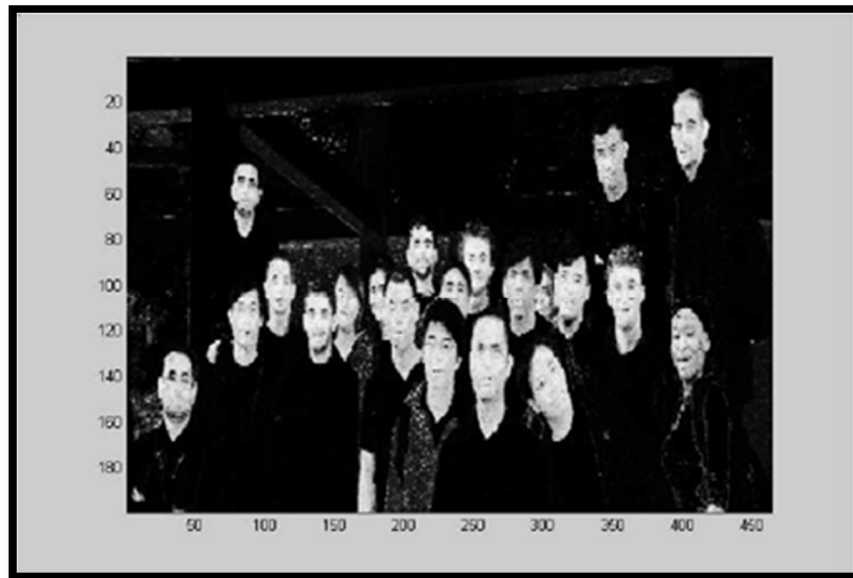
Ilustración 3.5 Imagen mostrando la probabilidad que dado un píxel, es un Pixel-Rostro. El color blanco significa una probabilidad más alta.
