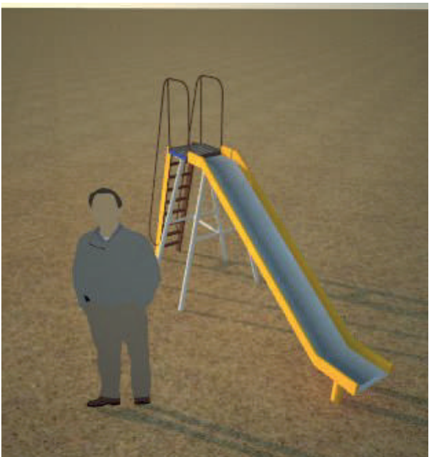
Juego de niños, hecho en caña guadua combinado con estructura metálica
