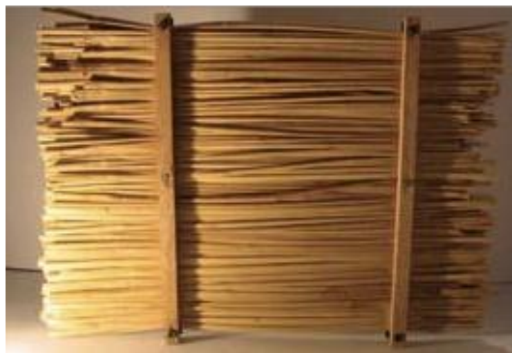
Imagen 7. Panel exterior con totora inmunizada.
