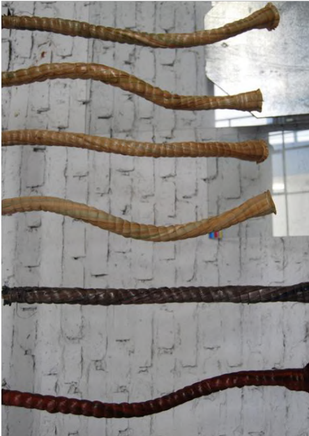
Imagen 5. Aplicación de aceite de lino a la fibra de totora.
