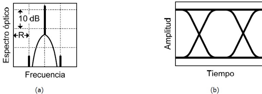
Figura 9 a) espectro óptico NRZ OOK, b) diagrama de ojo ideal NRZ OOK. Fuente: P. Winzer
