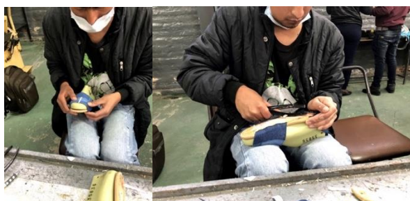
Figura 3.20 Templado de piezas en la horma
