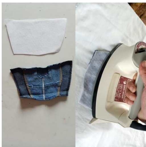
Figura 3.12 Colocación de entretela
