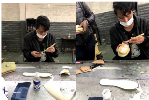
Figura 3.19 Colocación de cemento de contacto
