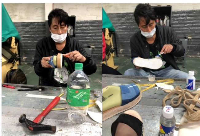
Figura 3.25 Colocación de líquido limpiador y pegamento blanco
