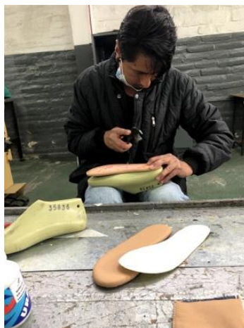
Figura 3.18 Rebajado de forro
