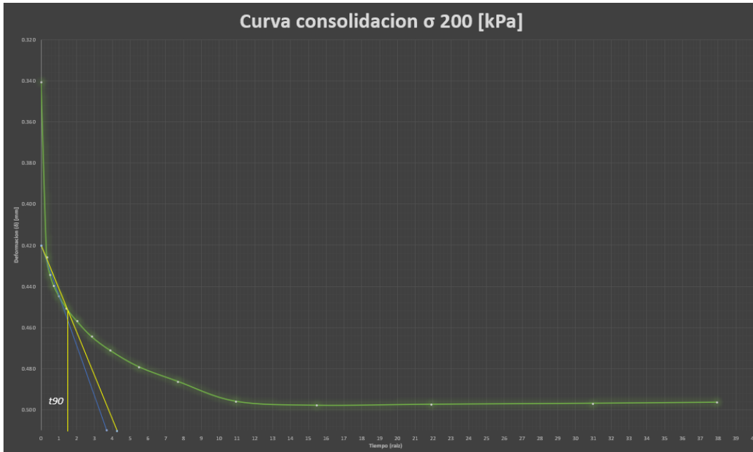
Ilustración 52 Curva de consolidación esfuerzo de 200 kPa - Taylor. Muestra 1 Fuente: Elaboración propia
