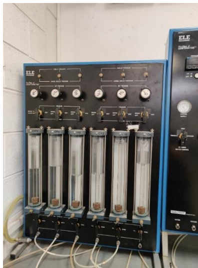
Ilustración 37 Tri – Flex 2: Panel de control auxiliar
