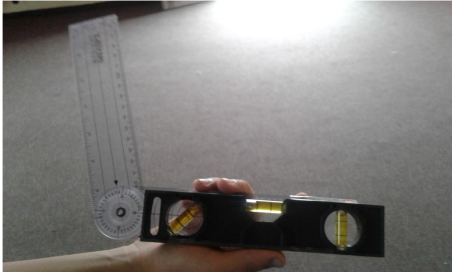
Figura 2. Goniómetro con brazo largo adaptado
