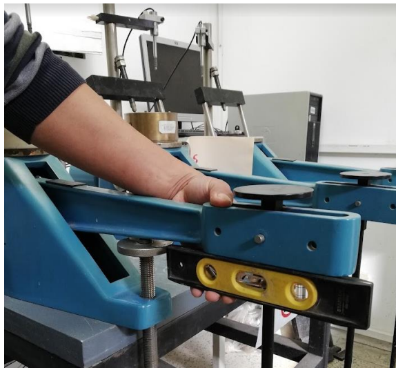
Figura 5.4. Nivelación del brazo de palanca del equipo de carga.
