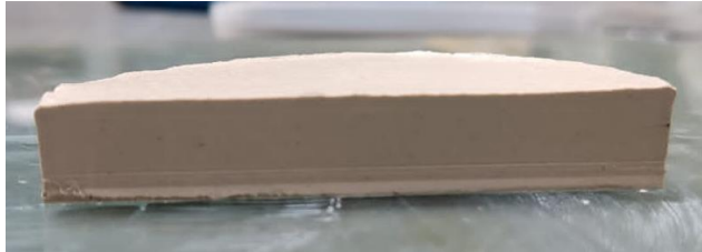
Figura 7.1. Verificación de uniformidad de las probetas previo al ensayo de consolidación.
