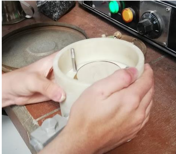
Figura 5.3. Expulsión de aire y distribución homogénea de la superficie mediante el impacto sobre una base sólida.
