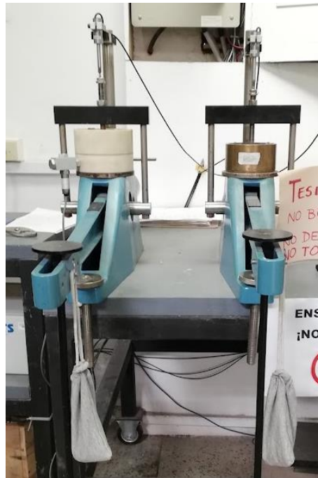
Figura 5.6. Proceso de precarga de la muestra.
