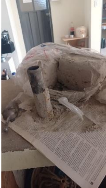
Ilustración 23.- Moldeo de muestra para el ensayo de compresión simple
