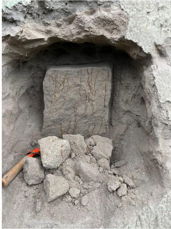
Ilustración 21.- Extracción de calicata Est-9 a 25 metros para ensayos.
