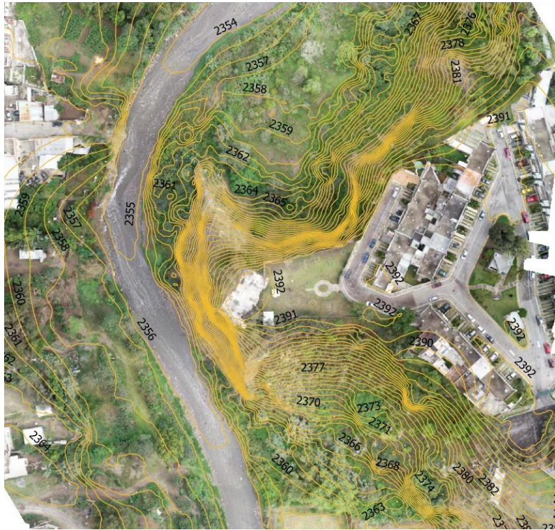
Ilustración 7.- Topografía obtenida con el dron del área de estudio.
