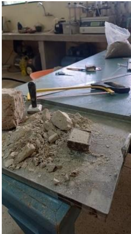
Ilustración 24.- Moldeo de muestra para el ensayo de corte directo.
