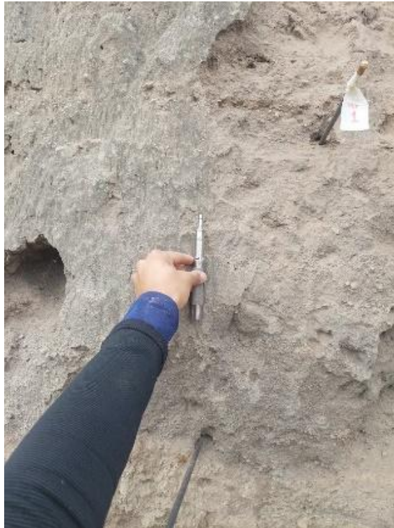
Ilustración 17.- Penetrómetro de bolsillo usado en el estrato uno.
