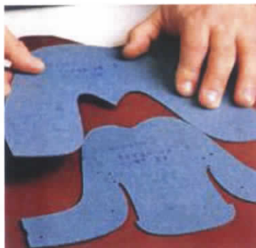
Gráfico 37 Colocación de Patrones para cortes
