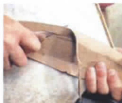
Gráfico 53 Desbaste del Contrafuerte
