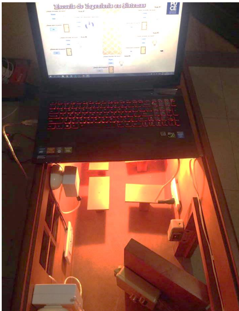
Ilustración 4.32: Encendido luces mediante el Sistema domótico
