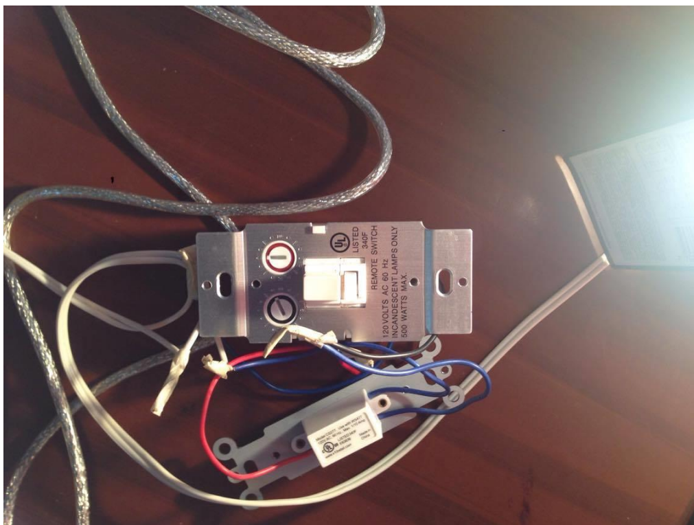
Ilustración 3.28: Control de luces mediante un Dimmer
