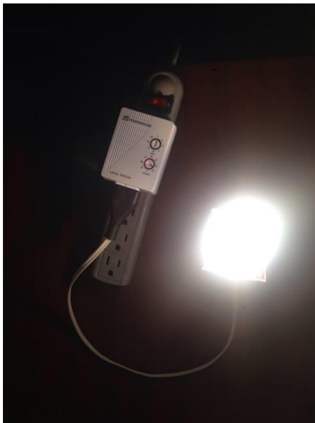
Ilustración 3.31: Encendido de luces mediante un Módulo de lámpara
