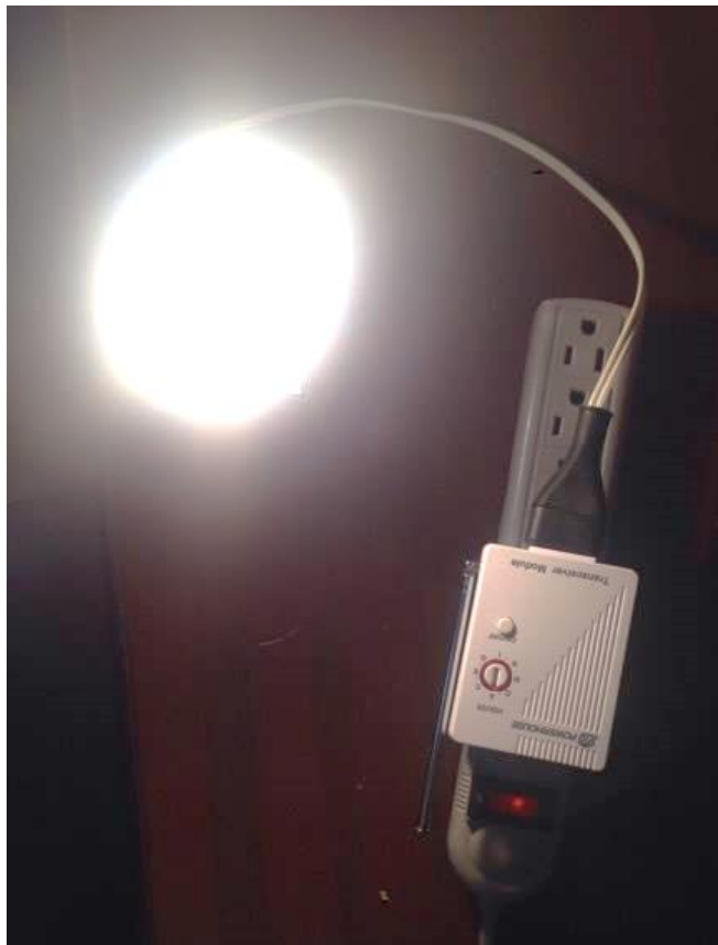
Ilustración 3.29: Encendido de la luz mediante RF Transceiver RM751
