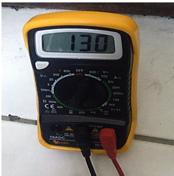
Ilustración 4.16: Medición voltaje línea eléctrica
