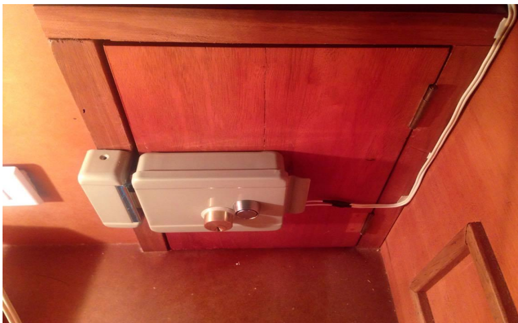
Ilustración 4.34: Cerradura eléctrica en la puerta de la maqueta
