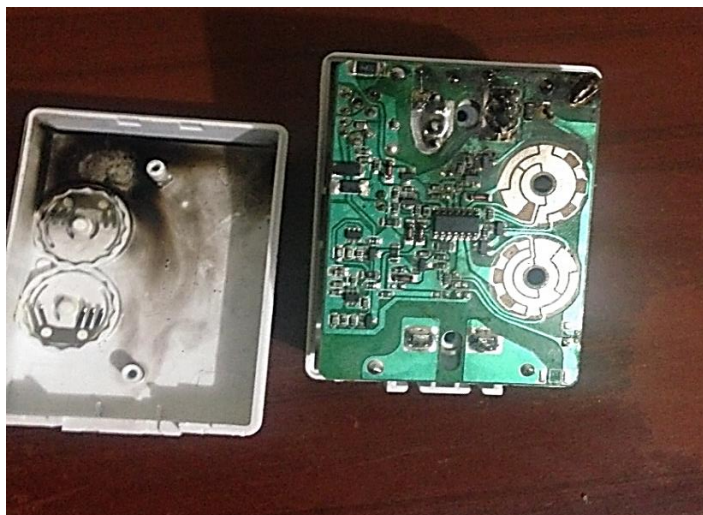
Ilustración 4.22: Apertura del Módulo de lámpara LM465
