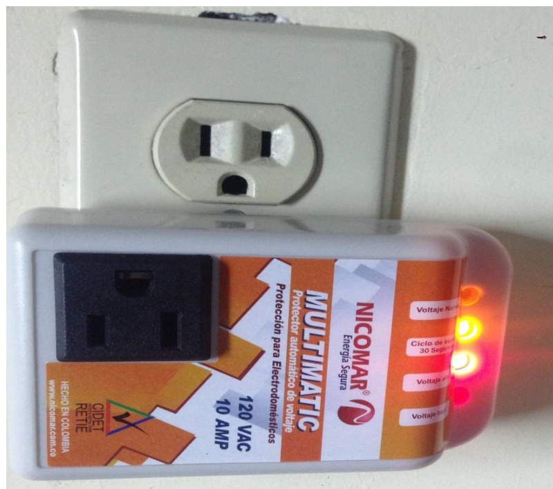
Ilustración 4.20: Regulador de voltaje
