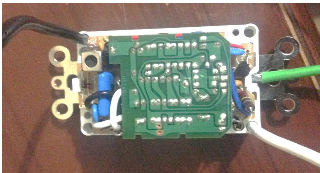
Ilustración 4.26: Apertura de SuperSocket Recetacle SR227
