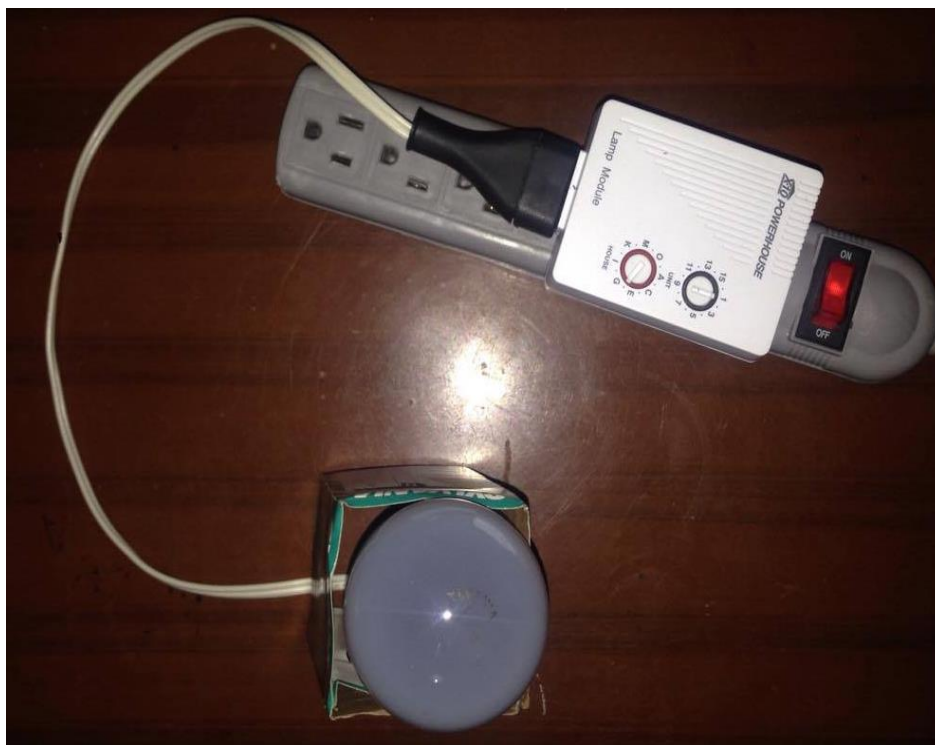
Ilustración 3.30: Conexión del Módulo de lámpara
