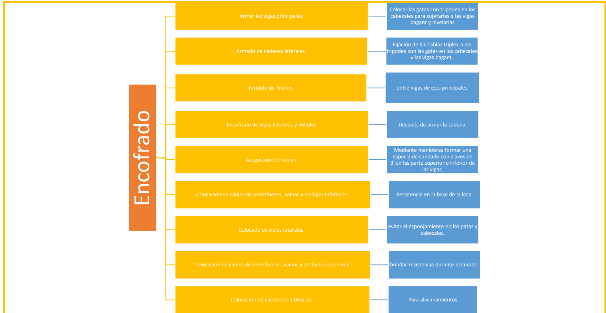
Ilustración 5.- Descripción del proceso de encofrado de losas.
