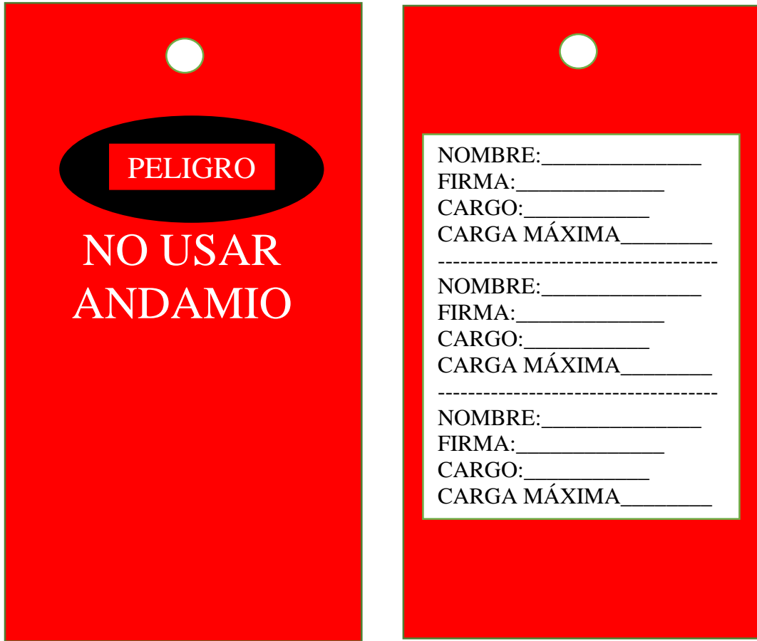
Ilustración 63.- Tarjeta de aprobación de andamios. NO USAR ANDAMIO.
