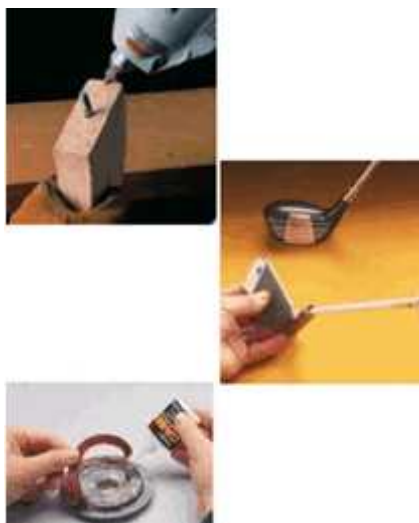
Imagen 2.11. Ensamble por adhesivos
