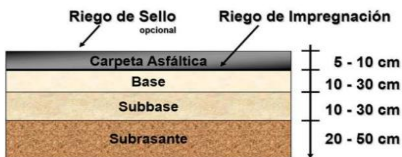
Figura 2.1 Estructura del pavimento asfáltico
