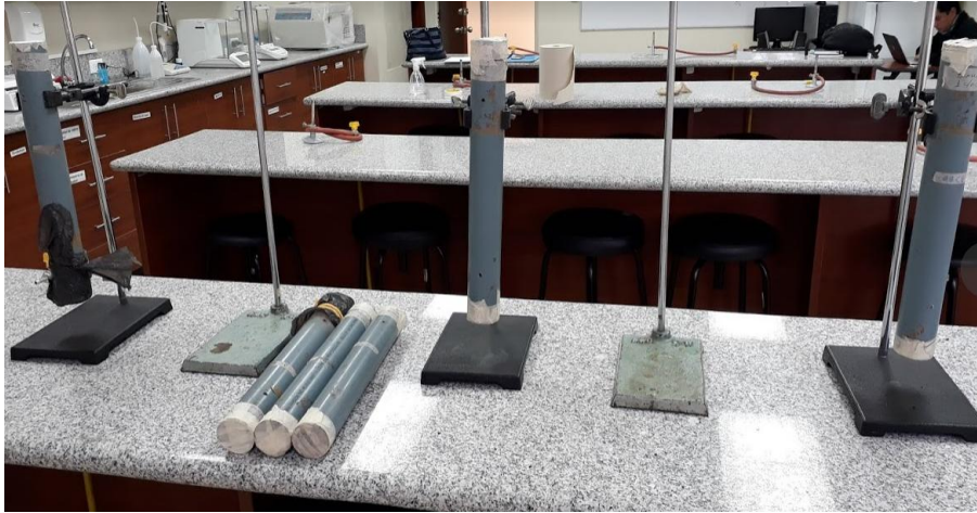
Fotografía 5. Preparación de las columnas de suelo en tubos PVC.
