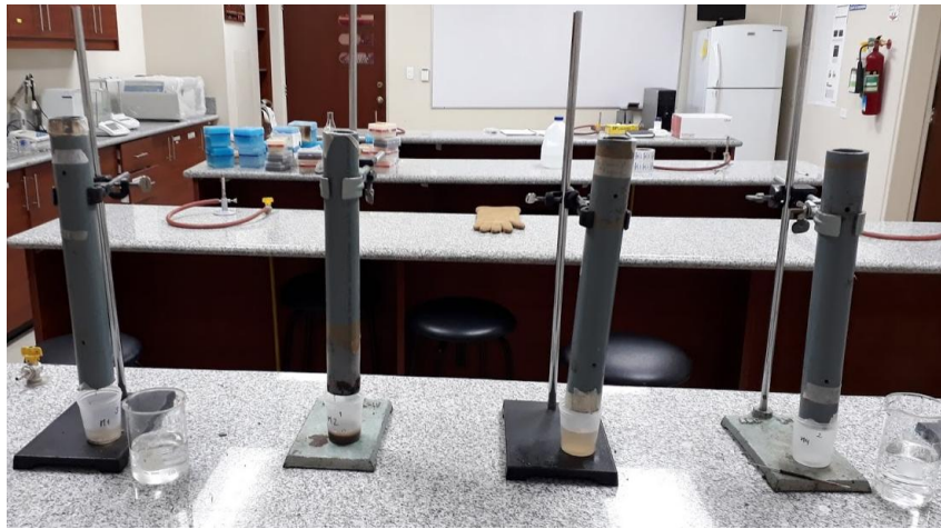
Fotografía 7. Columnas de suelo y frascos recolectores del lixiviado.
