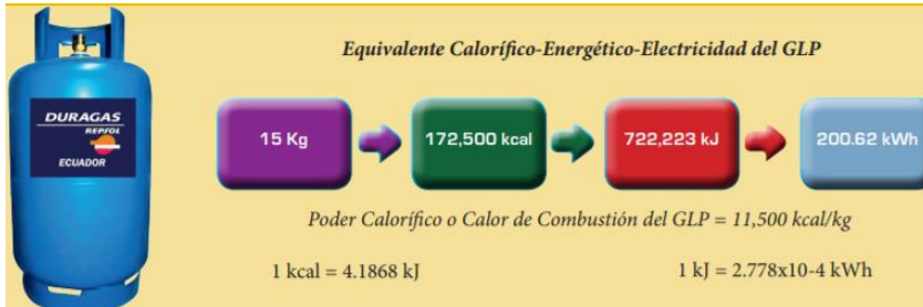
Figura 1. Equivalente calorífico del GLP
