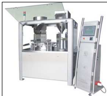
Figura No. 19: Empacadora de cápsulas
