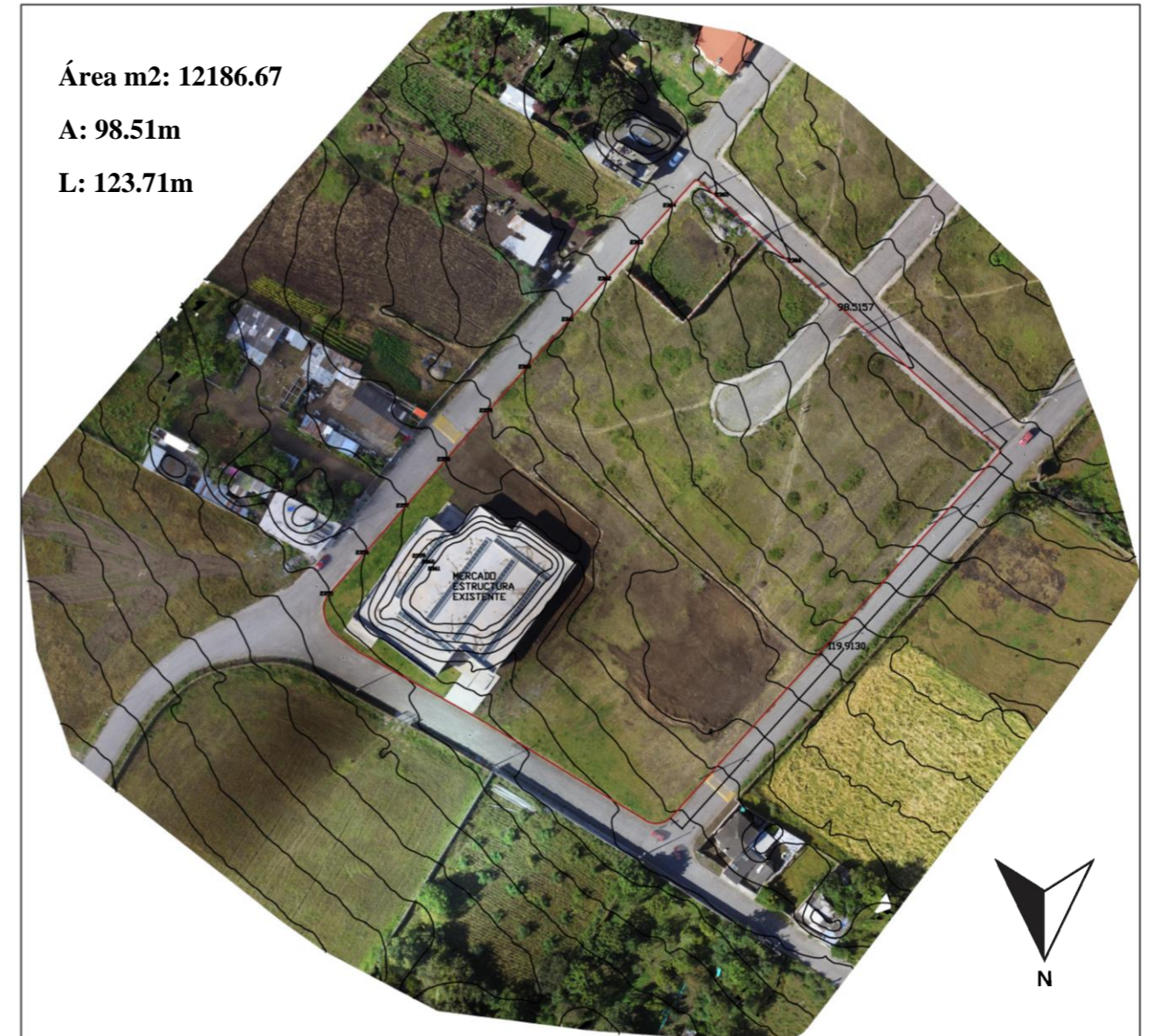
Ilustración 77 Curvas de Nivel Fuente: Elaboración propia
