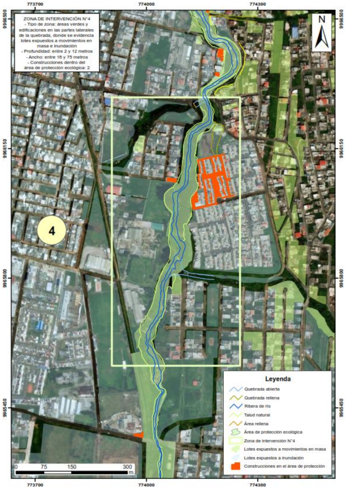
Figura 17. Quebrada Caupicho - zona de intervención 4, Áreas verdes y edificaciones en las partes laterales de la quebrada. Lotes expuestos a movimientos en masa e inundación Fuente: Elaboración propia, PUGS 2024
