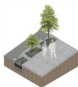
4 ARDINES INUNDABLES, REDUCTOR DE VELOCIDAD
