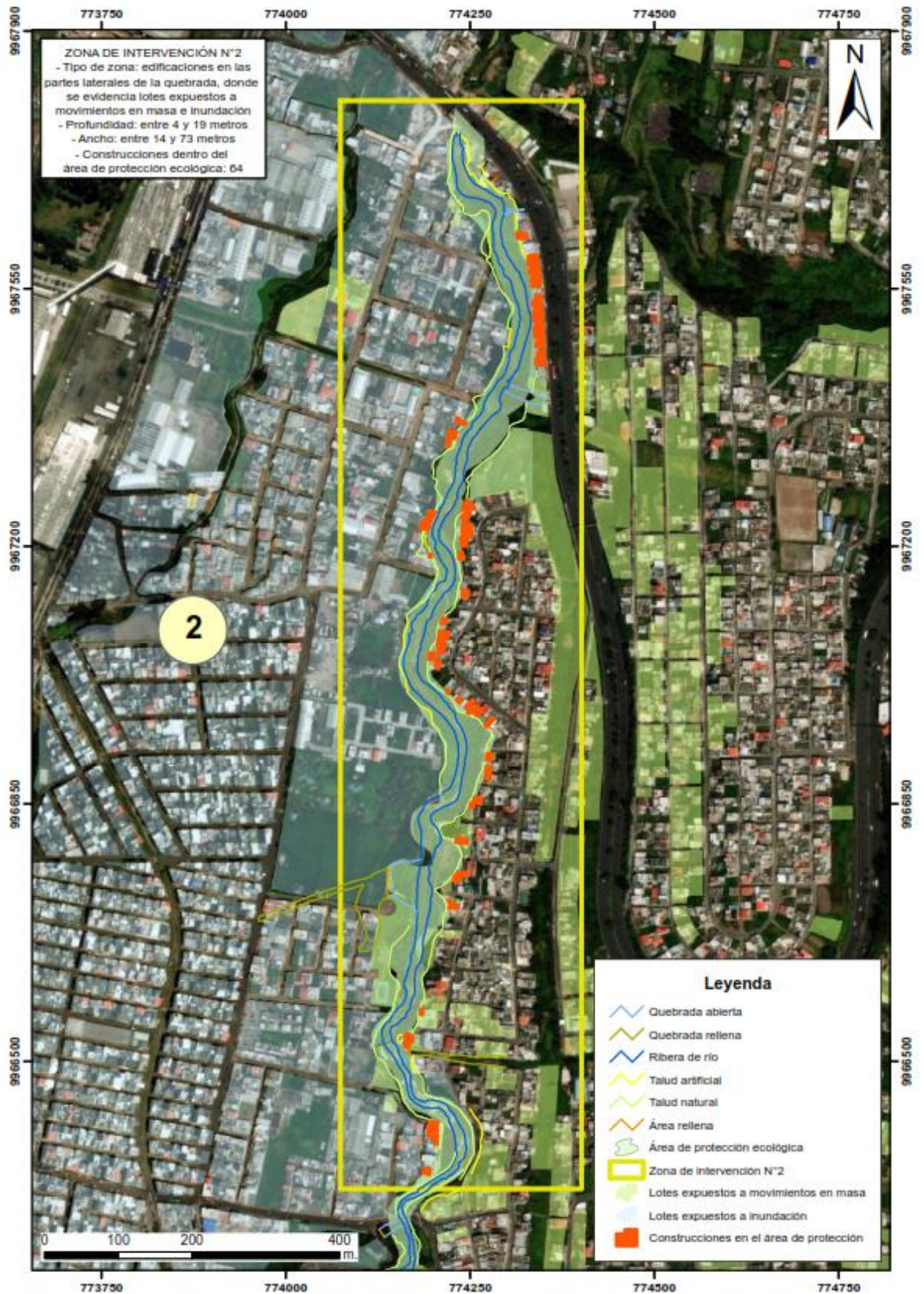
Figura 9. Quebrada Caupicho - zona de intervención 2, Edificaciones en las partes laterales de la quebrada. Lotes expuestos a movimientos en masa e inundación.
