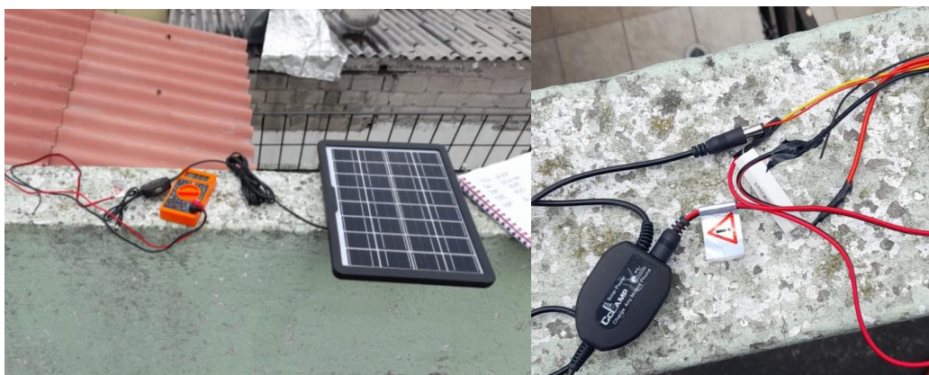
Figura 3. Montaje del panel y adaptación del panel para registro de valores
