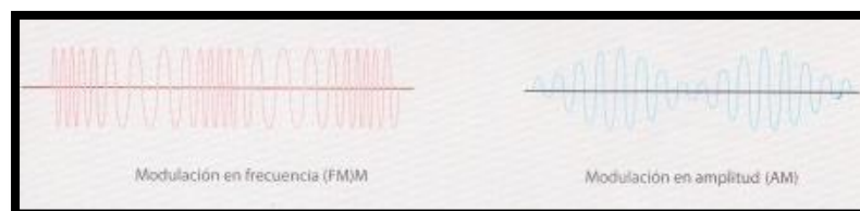
Figura 1.3 Transmisión de frecuencias en (AM) y (FM).
