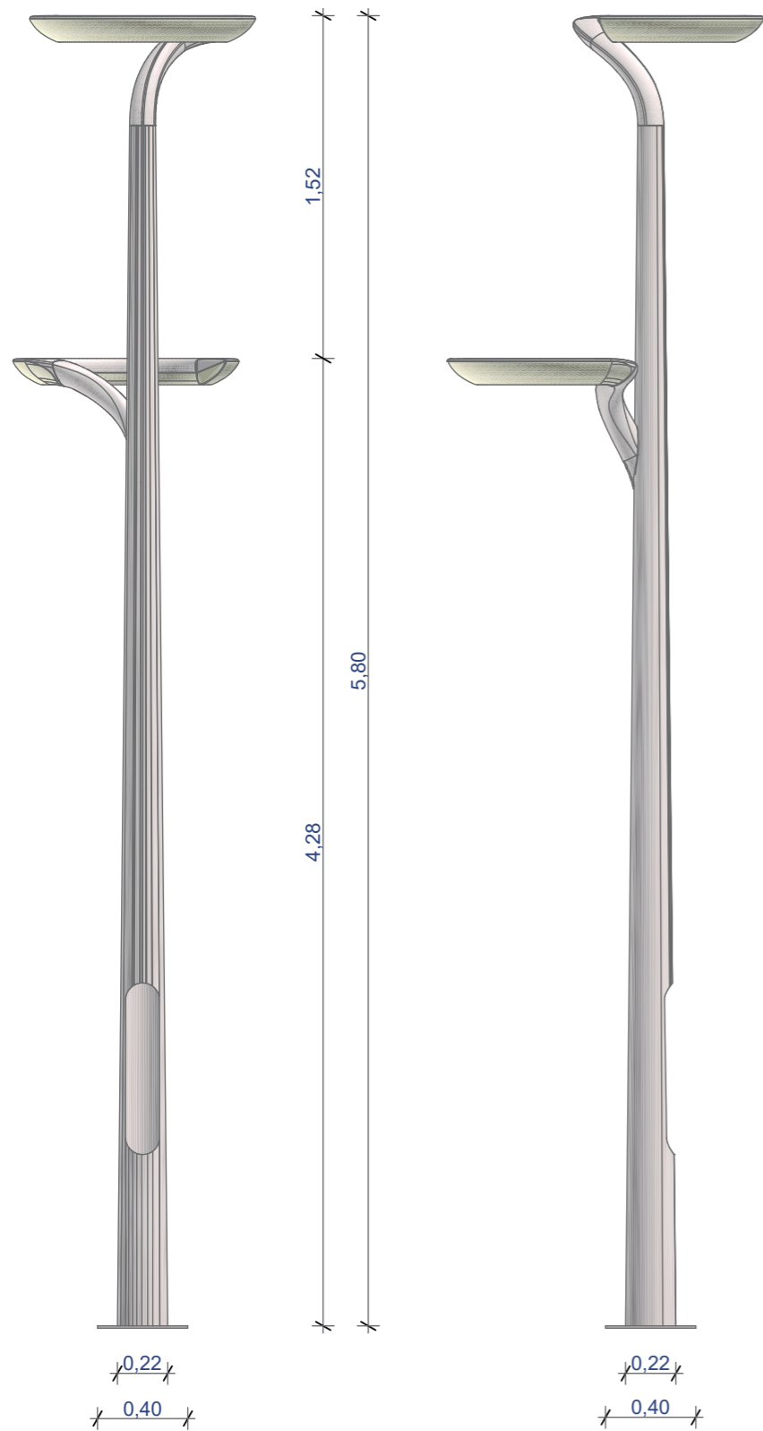
elevaciones frontal y lat. - luminaria tipo 1
