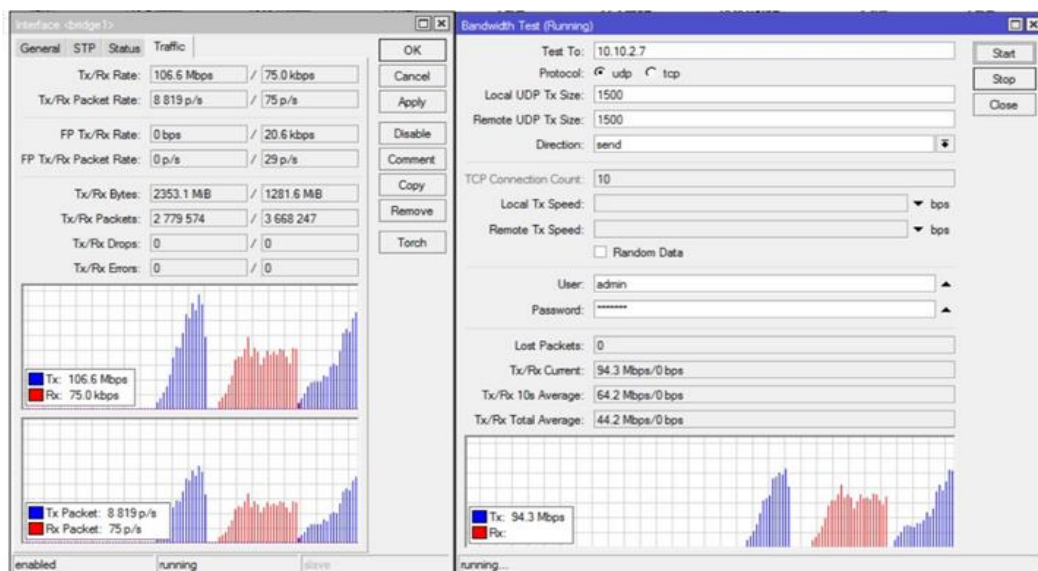
Figura 40: test de capacidad máxima con saturación nodo 2 Ambato
