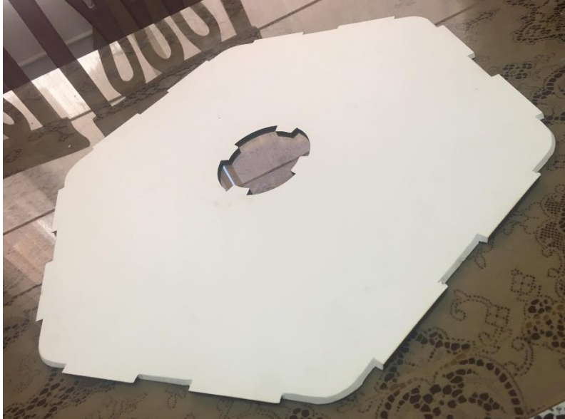
Imagen 27: filos de piezas lijados en ángulo para ensamble.
