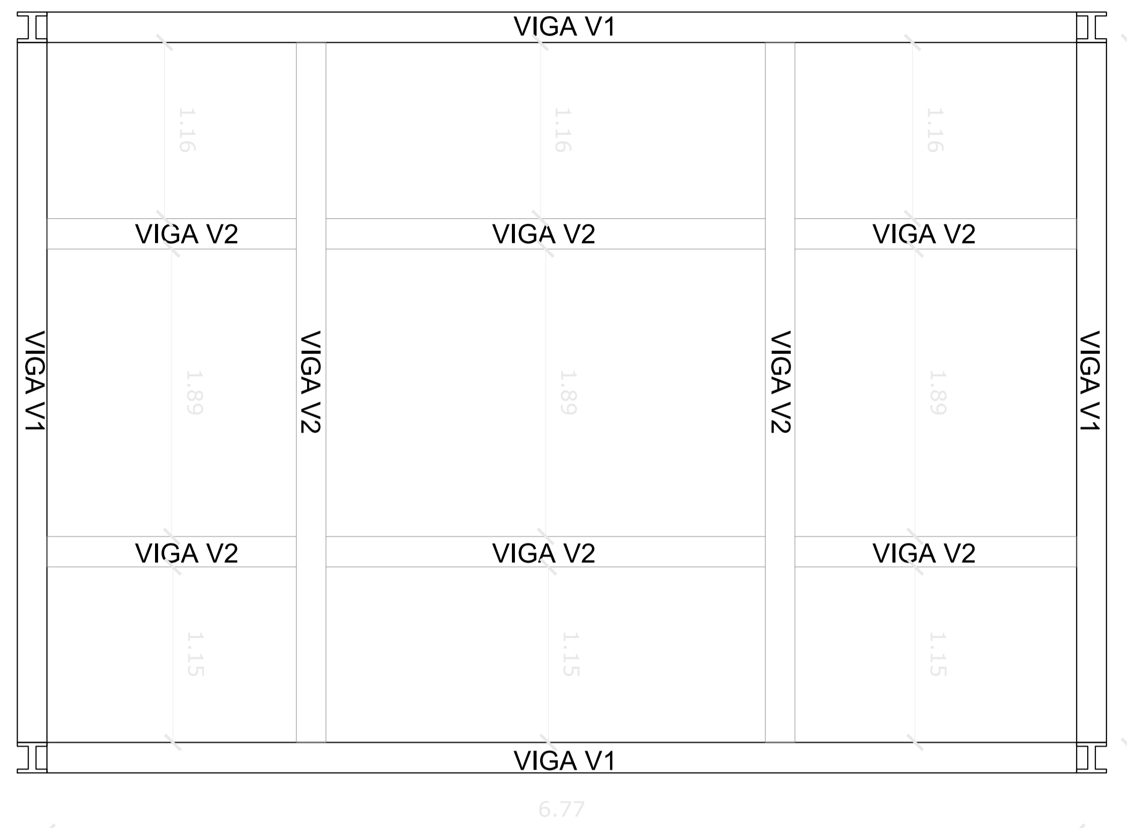
PLANTA DE VIGAS DE CUBIERTA ESC. 1.25
