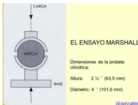
Imagen No 23 Ensayo Marshall Fuente: Ing. Luis Castillo
