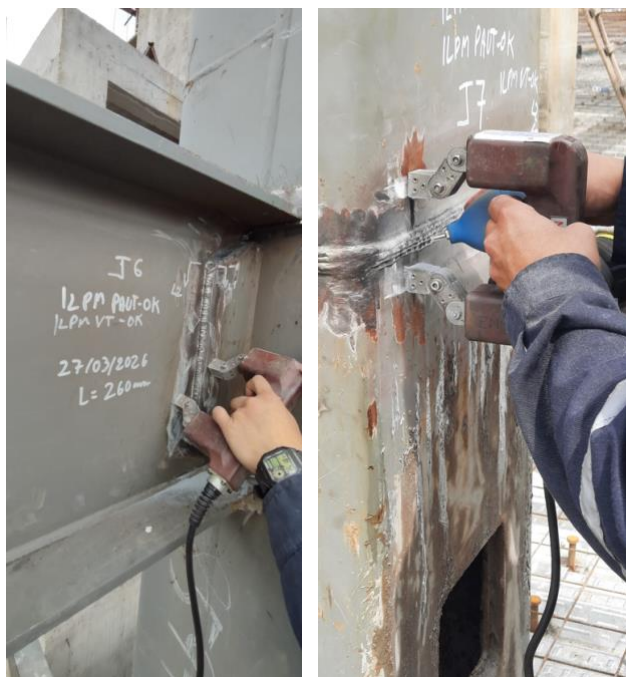
Figura 6: Ensayo por partículas magnéticas (MT) Fuente: Elaboración propia
