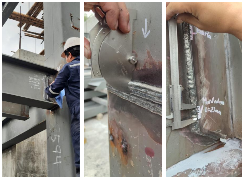
Figura 4: Ensayo de inspección visual (VT) Fuente: Elaboración propia
