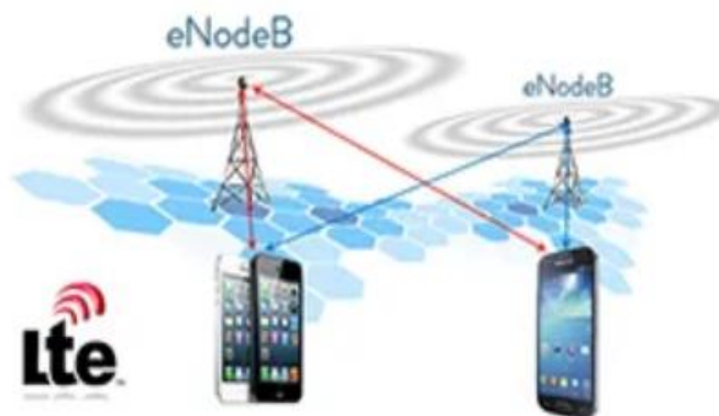
Figura 27.- Selección de radiobases LTE a través del RSRP Fuente: LTE RSSI, RSRP a RSRQ Measurement (CableFree, 2020)
