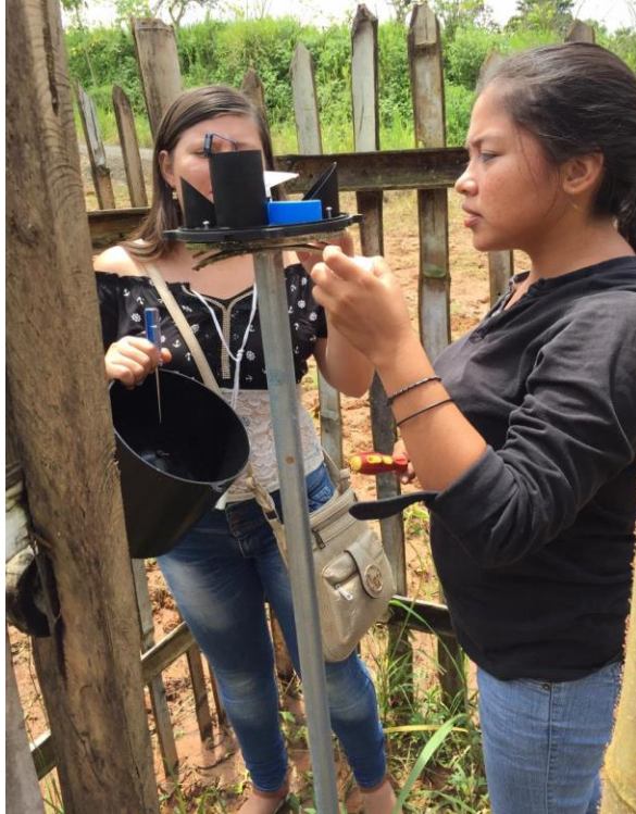
Instalación de pluviómetro para recolección de datos
