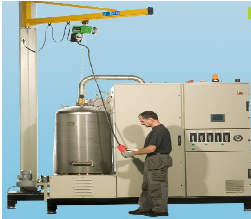
Figura 24. Máquina destiladora para la recuperación de mercurio
