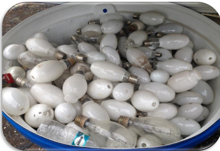
Figura 14. Tanque abierto que contiene los focos de mercurio
