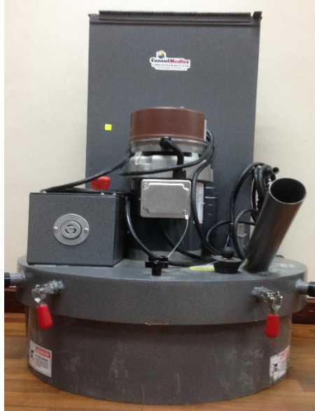
Figura 22. Máquina compactadora o trituradora de focos actual de la EEASA
