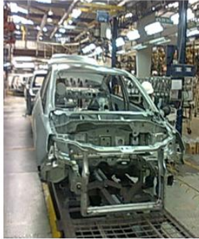
Colocación de Puertas, guardafangos y la cuadratura respectiva.
