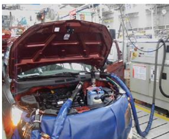
Operación de llenado de fluidos, donde el vehículo recibe agua, lubricantes, refrigerante y combustible.
