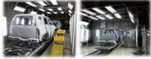
Proceso para eliminar imperfecciones de pintura Primer
