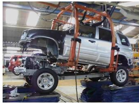
Operación de unión del chasis que contiene la suspensión delantera y posterior a la carrocería de una unidad de comerciales.
