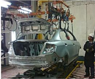
Después de pasar por todo el proceso de suelda se envía la unidad hacia la planta de Pintura.
