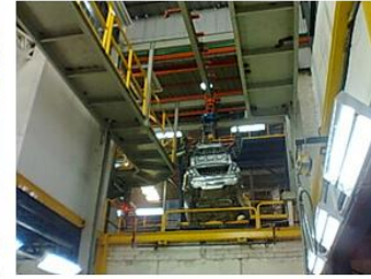
Consiste en ubicar los brazos del cargo bus en la carrocería y elevar la unidad para ser trasladada al siguiente paso del proceso.
