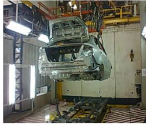
Consiste en ubicar los brazos del cargo bus en la carrocería y elevar la unidad para ser trasladada al siguiente paso del proceso.
