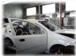
Proceso para limpiar y preparar la superficie para pintar Esmalte
