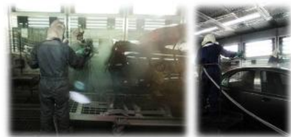
Proceso de pintura para dar color al auto La pintura llega lista a la línea para aplicación manual
