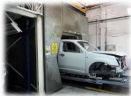
Proceso de curado de pintura Primer
