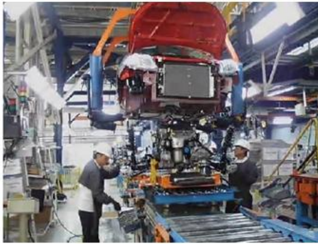
La operación de unir la suspensión delantera y posterior a la carrocería de una unidad de pasajeros es conocida como matrimonio.
