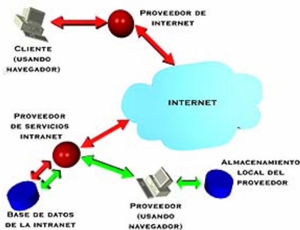
2.3 Esquema de una Intranet Común
