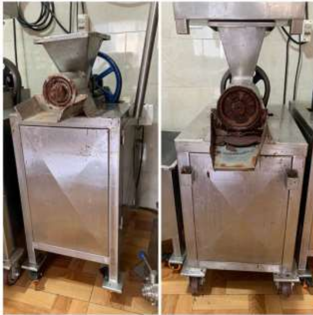
Registro fotográfico 4. Molinos para la fabricación del chocolate
