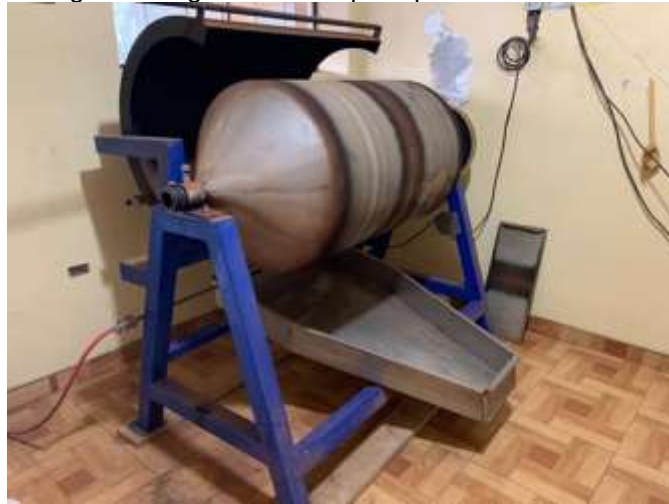
Registro fotográfico 6. Máquina para tostar el cacao
