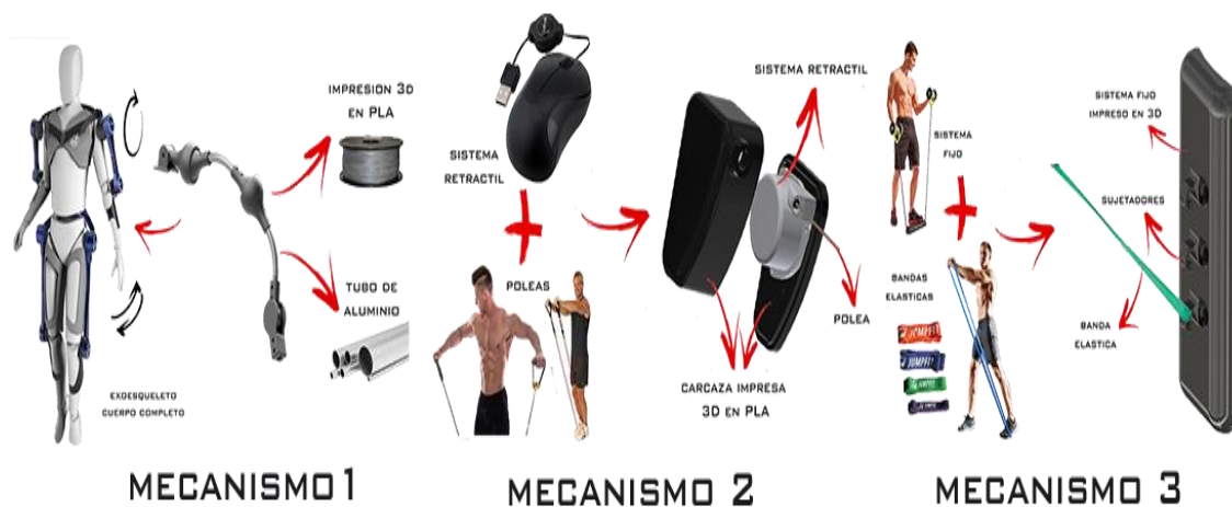
Figura 4.2. M1) Exoesqueleto, M2) Sistema retráctil, M3) Sistema de ligas: Propuestas realizadas.
