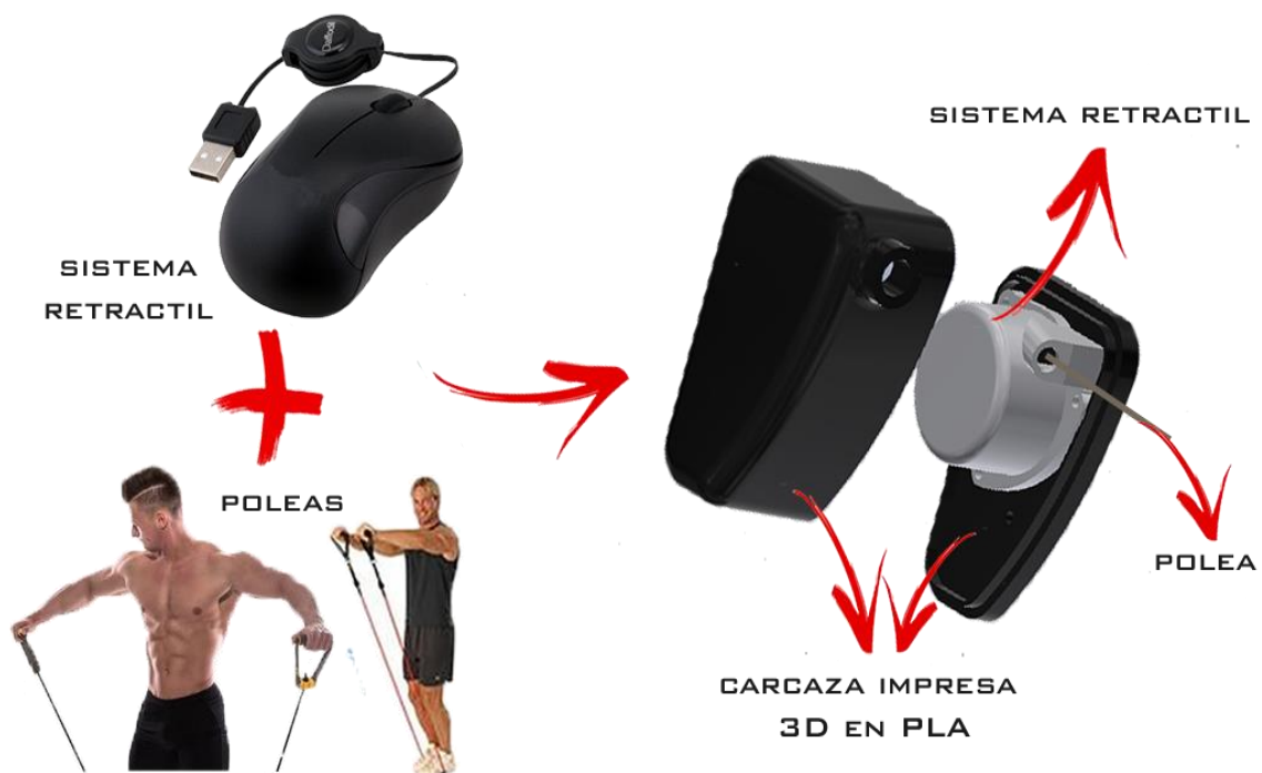
Figura 3.4. Propuesta mecanismo 2, Sistema retráctil.
