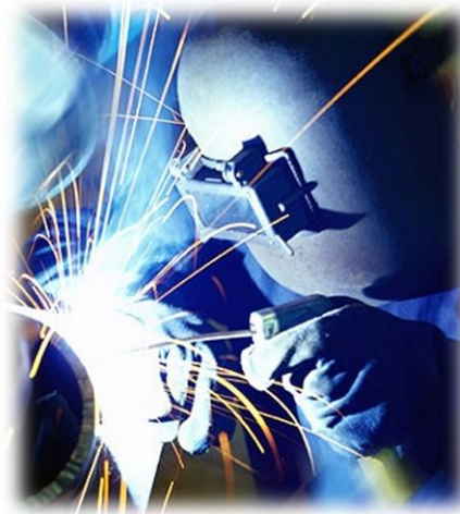
Imagen 27: Soldadura por arco
