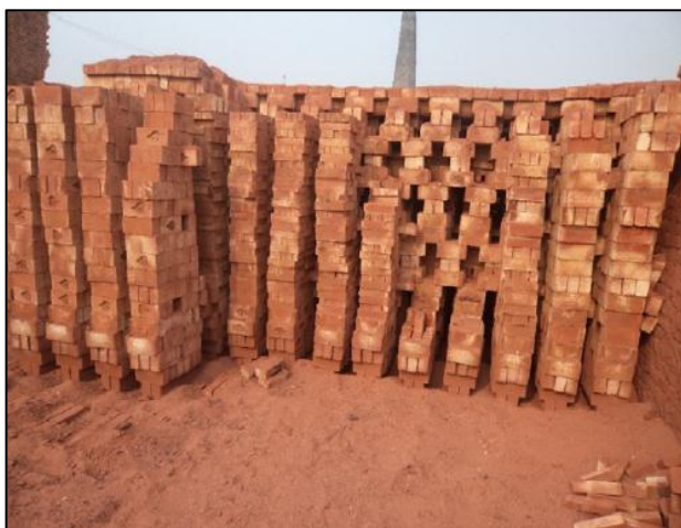
Figura 6. Mampuestos ecológicos cocidos fabricados con cenizas de bagazo de caña de azúcar y cenizas de cáscara de arroz (Kazmi, Abbas, Saleem, Munir, & Khitab, 2016).
