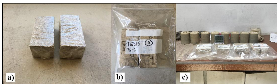
Figura 61. Preparación y curado de mampuestos tras corte en el LMC-PUCE: a) 1° capa de protección con película plástica, b) 2° capa de protección con bolsa plástica de cierre hermético, c) colocación en cuarto de curado.
