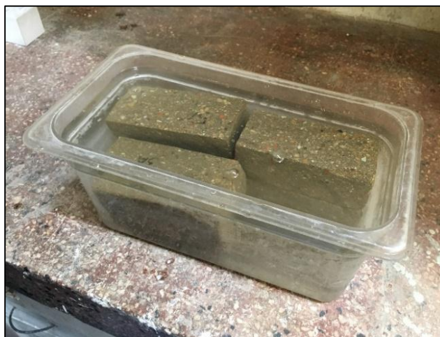
Figura 65. Absorción de mampuestos.
