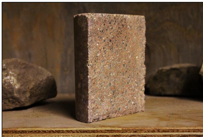
Figura 12. Mampuesto fabricado con geopolímeros de polvo de silicato de potasio (Noble Alchem Private Limited, 2019).
