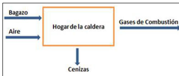
Figura 28. Proceso de combustión de bagazo (Alderetes, 2016).
