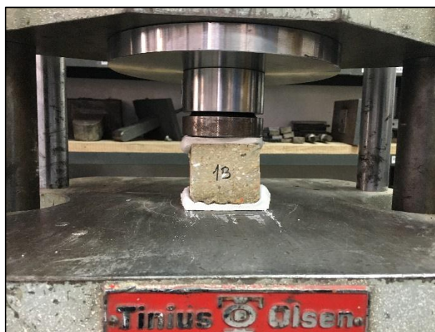
Figura 62. Compresión simple sobre mitad de mampuesto.
