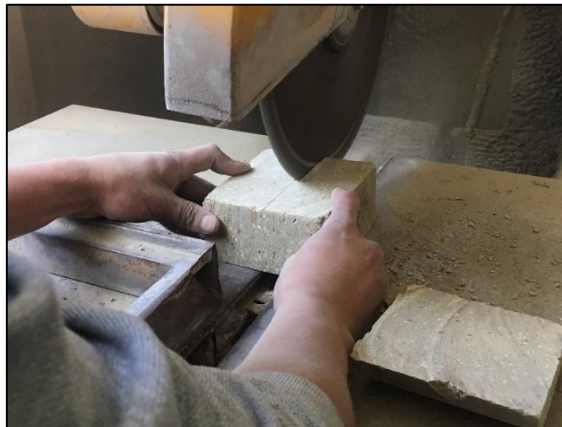
Figura 56. Corte final para la obtención de mampuestos.
