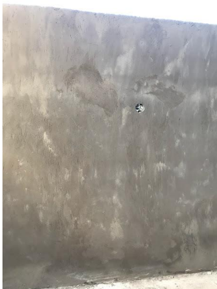
Ilustración 25: Análisis visual de la pared enlucida con mortero tradicional, primer día
