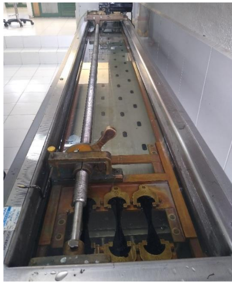
Figura 2.13. Ensayo ductilidad del asfalto
