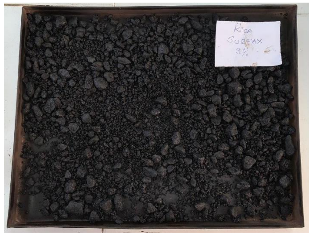
Figura 4.5. Ensayo RICE con Surfax TB1
