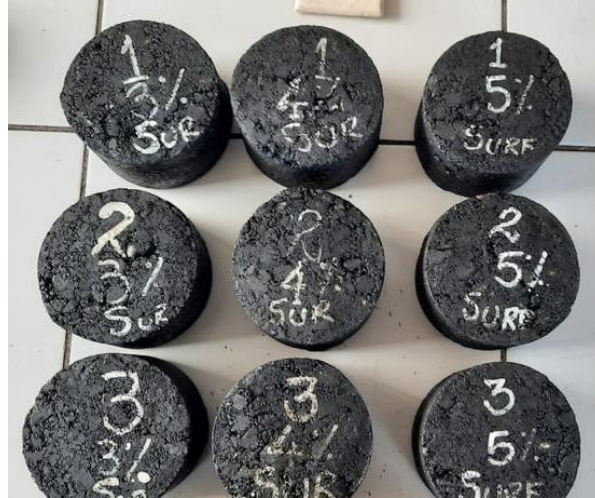
Figura 4.4. Briquetas de mezcla asfáltica con Surfex TB1
