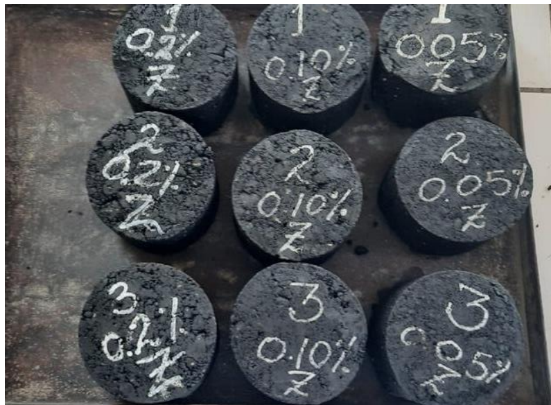
Figura 4.2. Briquetas de mezcla asfáltica con Zycotherm
