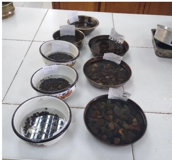
Figura 2.6. Desgaste a los sulfatos material grueso
