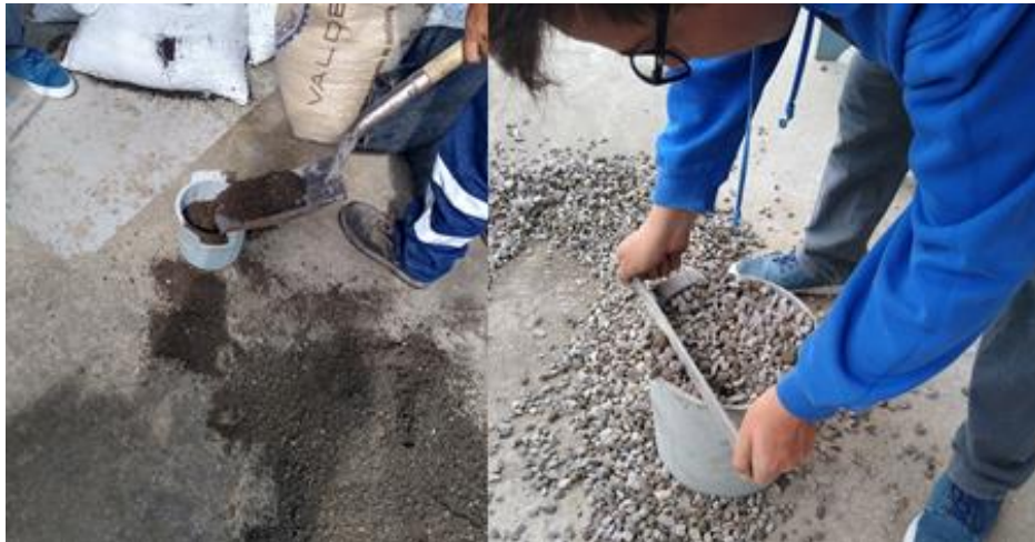
Figura 2.5. Ensayo peso unitario de áridos (INEN 858, 2010)
