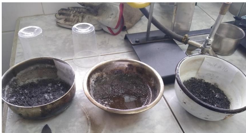
Figura 2.7. Desgaste a los sulfatos material fino
