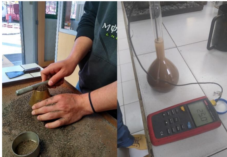
Figura 2.3. Gravedad específica (Método del picnómetro) (ASTM C128, 2015)
