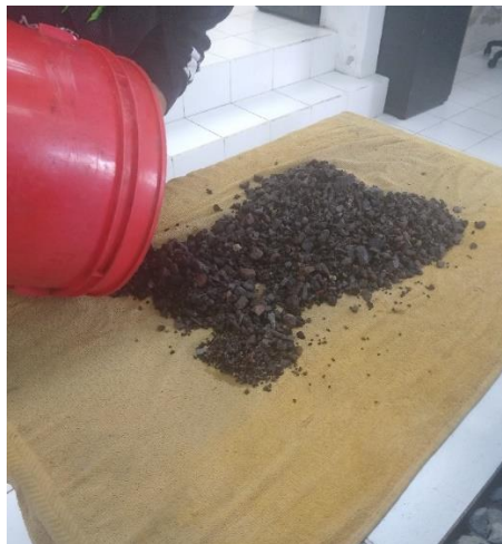
Figura 2.2. Gravedad Específica y porcentaje de absorción (ASTM C127, 2015)
