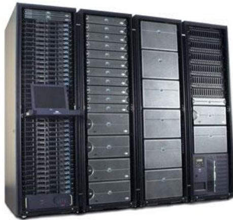
Figura 3 Centro de Datos tradicional (Servidores de montaje en rack)
