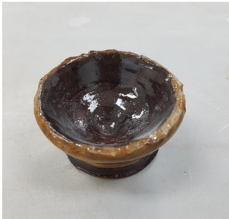
Imagen 4.27 Resultado de la aplicación de vidriado "negro"
