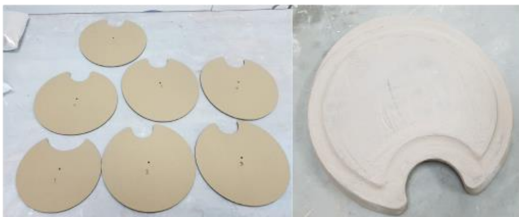
Imagen 3.17: Modelo de estudio Plato tendido, piezas cortadas a láser
