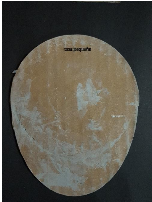
Imagen 3.22: vista superior de la taza pequeña - pieza de cartón cortada a láser
