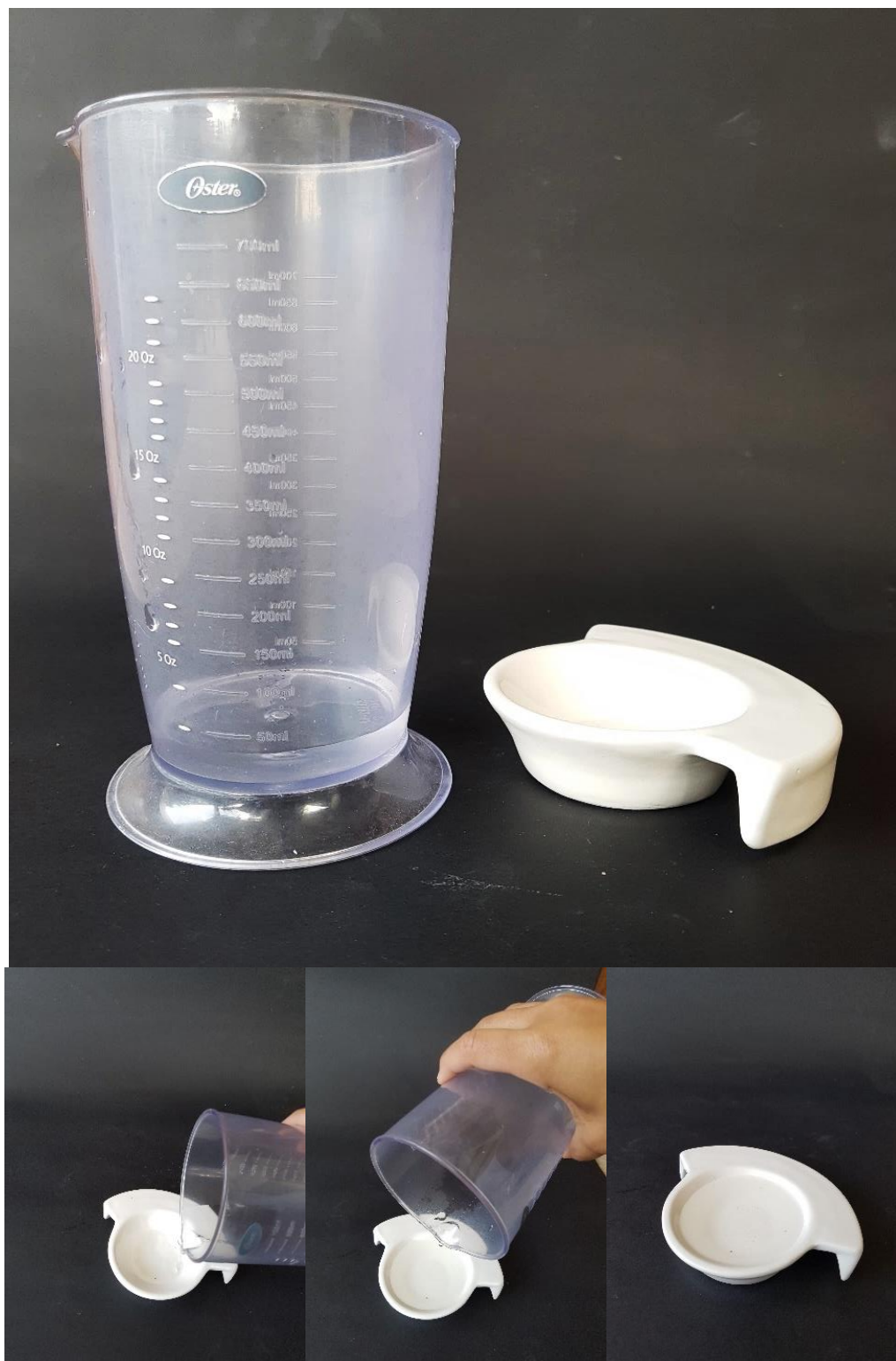
Imagen 4.72: Comprobación volumétrica de contenido del ajicero
