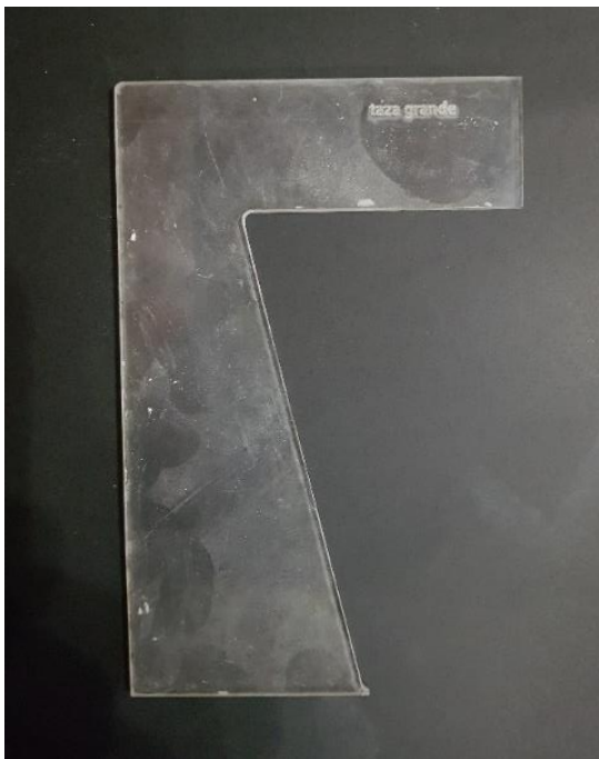
Imagen 3.20: Taza grande - Perfil de acrílico cortada a láser
