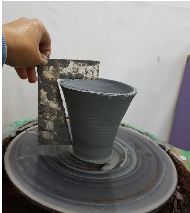
Imagen 4.55: Taza grande - pieza elaborada en torno
