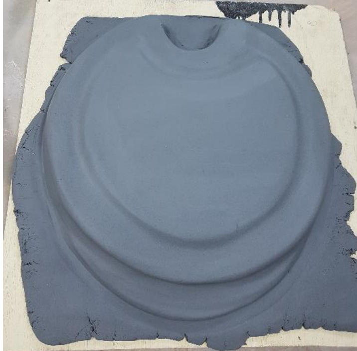
Imagen 4.32: arcilla en plancha tendida sobre el positivo del plato tendido
