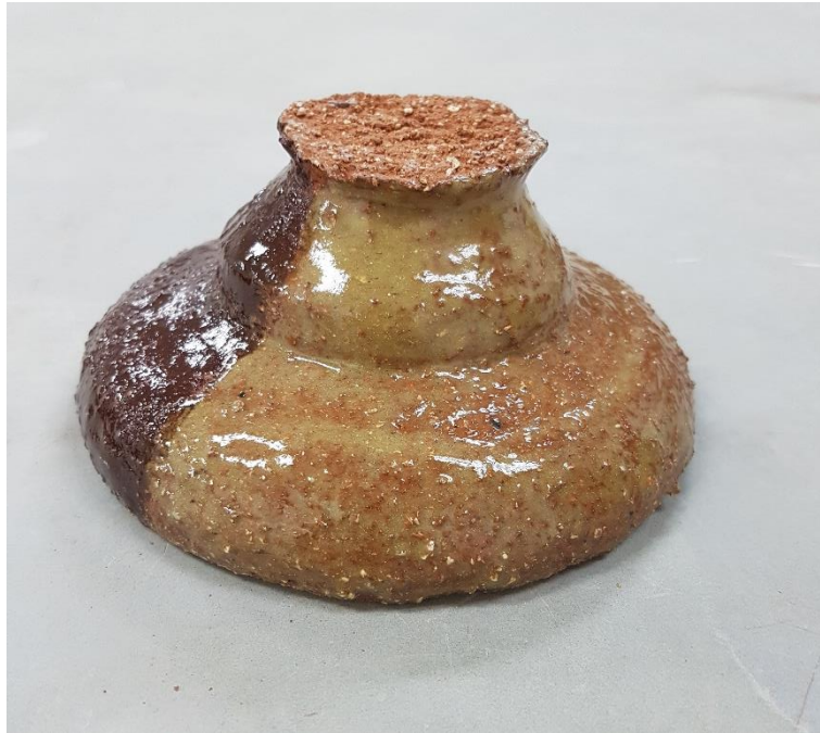
Imagen 4.30 Aplicación del vidriado "negro" y "azul" - resultado café y transparente respectivamente.
