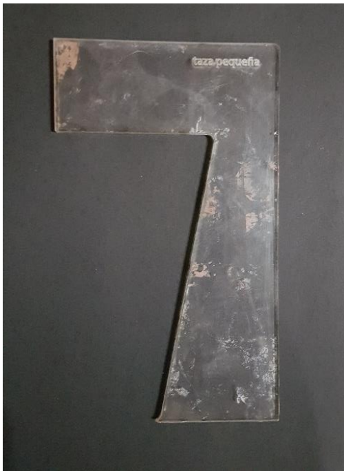
Imagen 3.23: Taza pequeña - perfil acrílico cortado a láser
