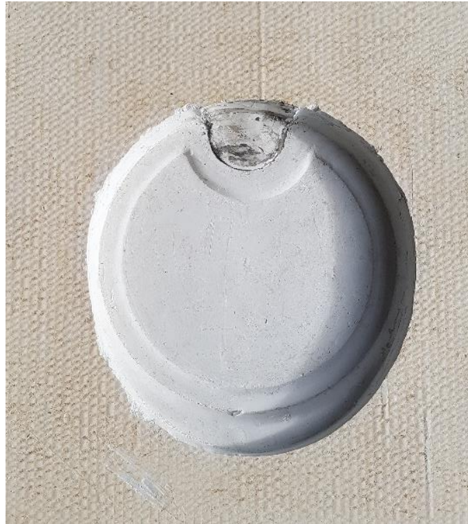
Imagen 4.40: Se extrae el positivo y se observa la calidad de la forma
