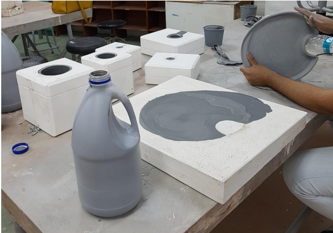
Imagen 64 Moldes de las piezas, colado en barbotina
