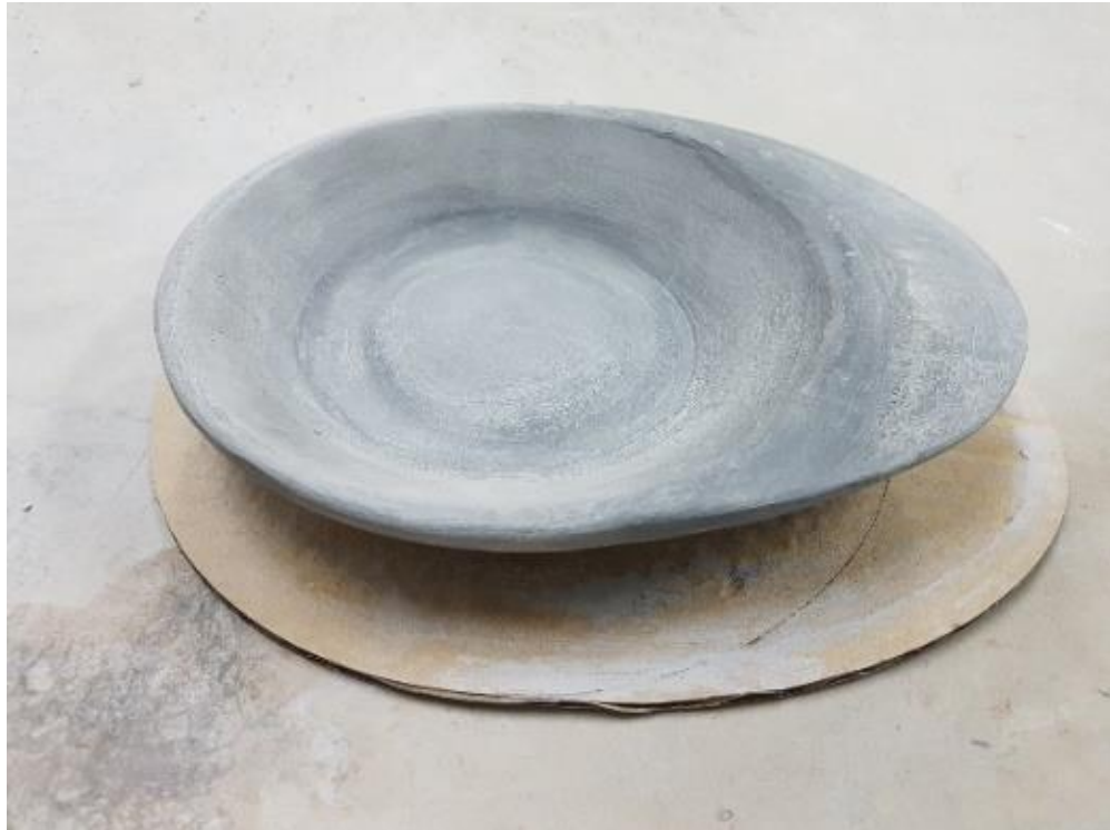
Imagen 4.50: Plato hondo - pieza en estado de cuero ya añadida la pestaña de sujeción.
