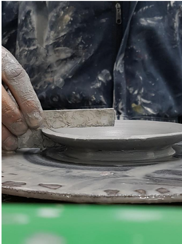
Imagen 4.57: Plato base - Elaboración en torno de la primera pieza
