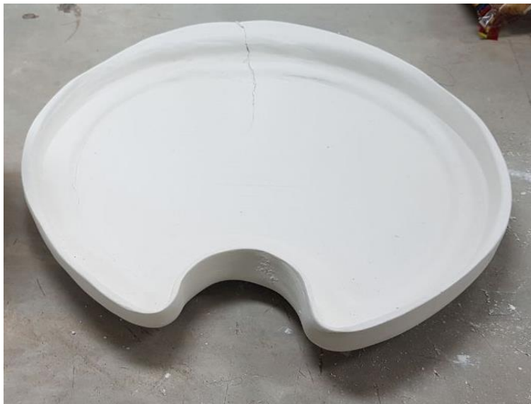
Imagen 4.35: Pieza curada en estado de biscocho
