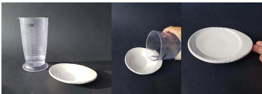
Imagen 4.76: Comprobación volumétrica de contenido del plato base para tazas
