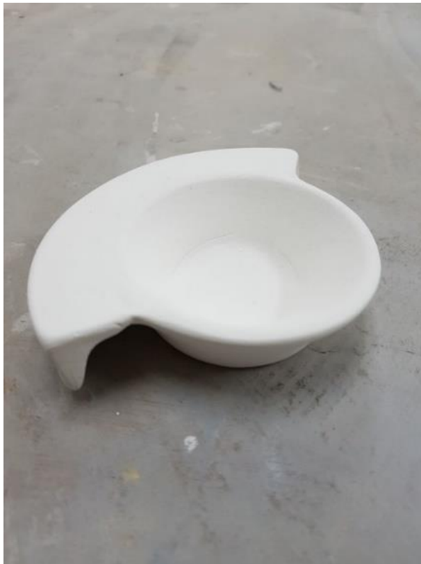
Imagen 4.45:Ajicero - pieza salida del horno en estado bizcocho
