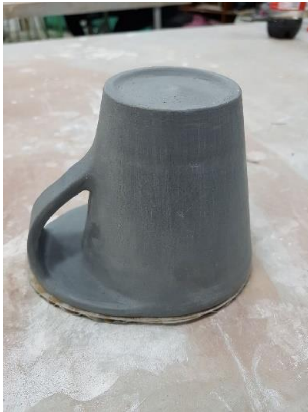
Imagen 4.53: Taza pequeña - estado de cuero de la pieza con todas sus partes unidas
