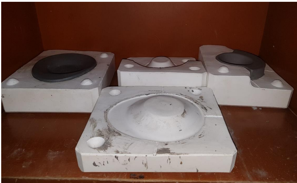
Imagen 65 Algunas piezas en secado en sus respectivos moldes
