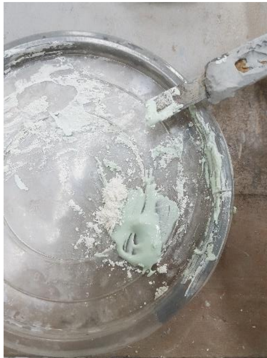
Imagen 4.60: Elaboración de una pasta con vidriado para curar trizados en bizcocho
