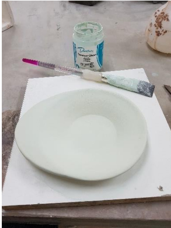
Imagen 4.62: plato base - proceso de pintura de la pieza en estado bizcocho
