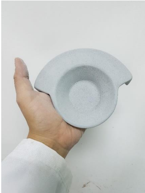
Imagen 4.44:Ajicero pieza de acilla totalmente seca y pulida antes de entrar al horno - relación mano-objeto
