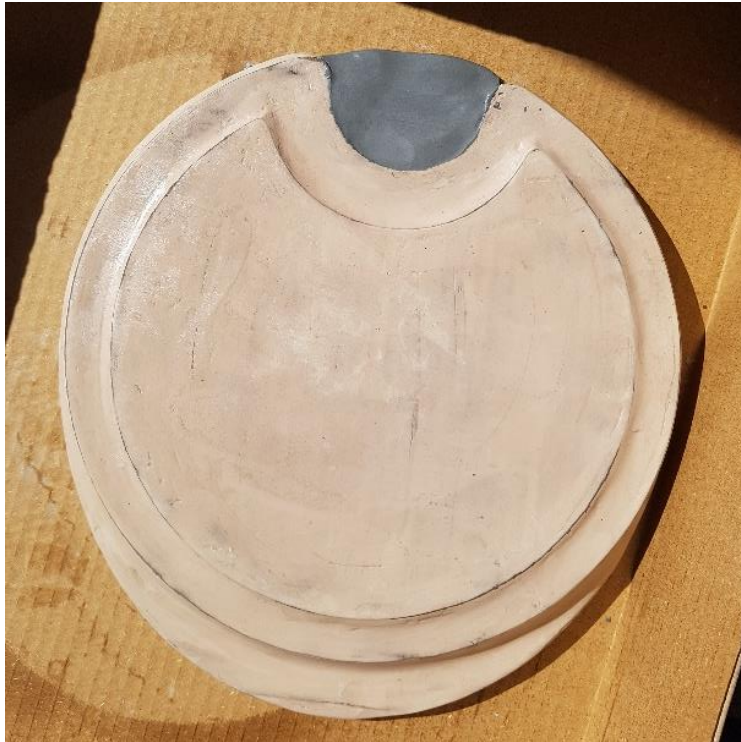
Imagen 4.38: se rellena el espacio con arcilla para evitar retenciones en el molde
