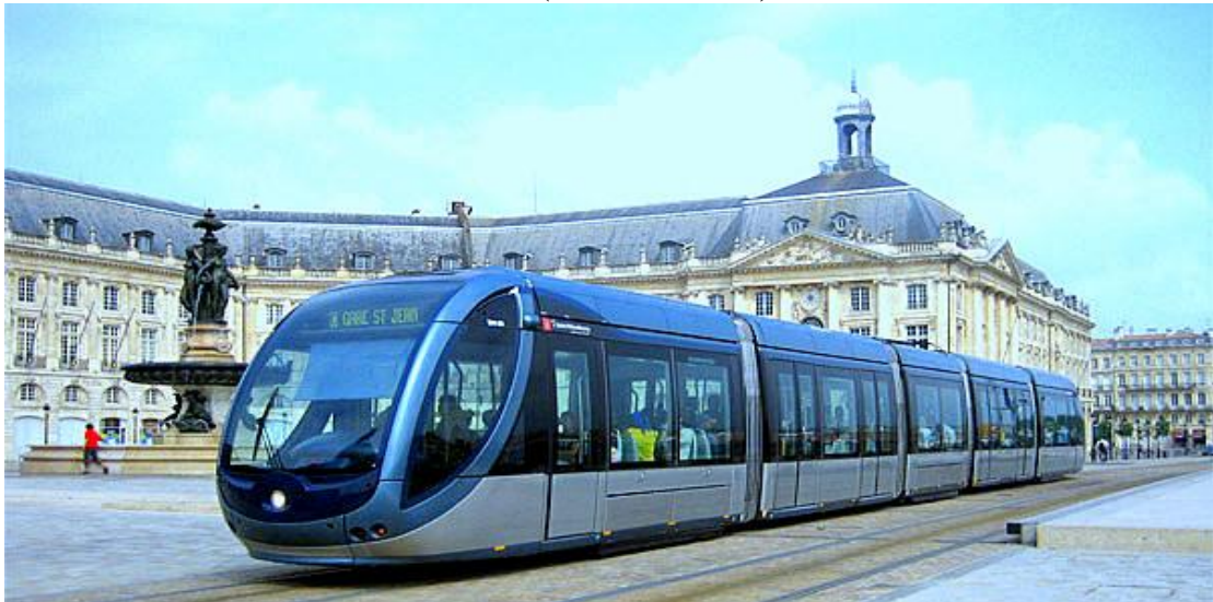
Figura 2. 8 Metro ligero, el cual no utiliza catenarias y cableado convencionales del tranvía o trolebús (Burdeos-Francia).
