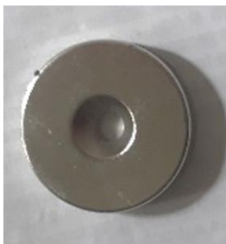
Figura 4. Imán de neodimio usado en la investigación
